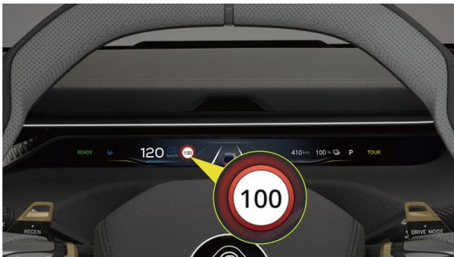
L'allarme si attiva quando la velocità del veicolo supera il limite di velocità riconosciuto dal sistema; l'allarme viene disattivato quando la velocità del veicolo è inferiore al limite di velocità riconosciuto dal sistema fino a quando non viene rilevato un nuovo limite di velocità.
