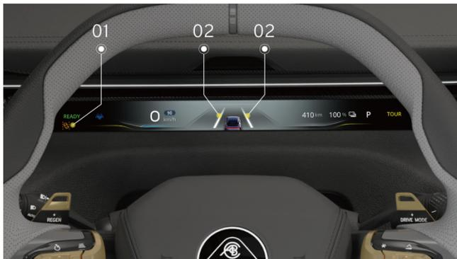
1. Spia di stato dell'assistenza al mantenimento della corsia
