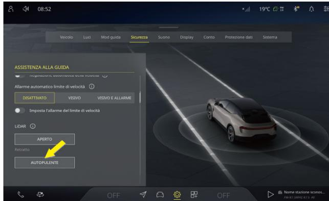
Quando il veicolo è acceso e la leva del cambio è in posizione P, il LiDAR anteriore può essere pulito manualmente con un solo tocco secondo necessità. Il LiDAR non può essere pulito manualmente in presenza di una delle seguenti condizioni:
