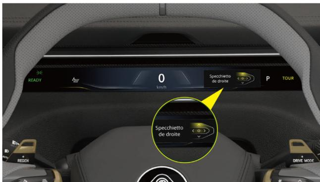
**Interfaccia di regolazione dello specchio in streaming tramite pulsante del volante\***
