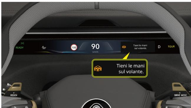
Quando il sistema LKA è attivo, il conducente deve tenere sempre il volante con entrambe le mani. Quando il sistema LKA viene attivato per la prima volta e rileva che il conducente non sta tenendo il volante, sul quadro strumenti non viene visualizzato
