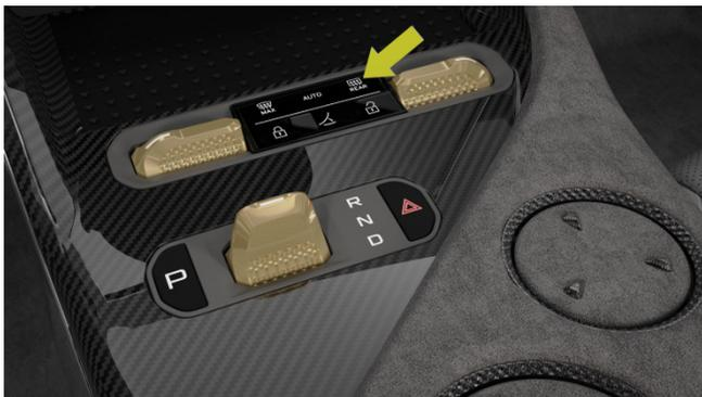
Riscaldamento degli specchietti retrovisori esterni tramite la console anteriore
