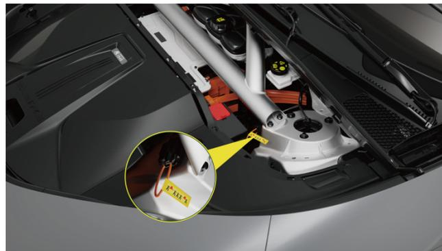
4. Individuare l'MSD a basso voltaggio nel cofano e rimuoverlo; il veicolo disattiverà automaticamente il sistema ad alta tensione.
