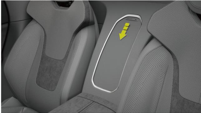
La tasca dello schienale del sedile posteriore si trova al centro dello schienale del sedile posteriore ed è premuta verso il basso fino al blocco inferiore; premere di nuovo e chiudere automaticamente.
