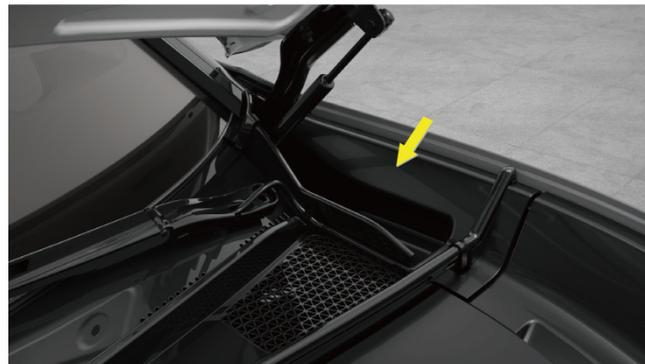
3. Spingere la leva di blocco dello sportello della presa di ricarica all'indietro per sbloccare lo sportello della presa di ricarica e poi estrarlo dalla fessura e aprire lo sportello della presa di ricarica.
