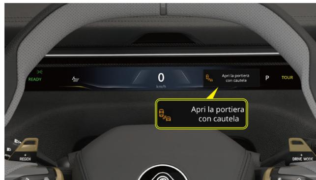
Se il sistema DOW rileva un target e sussiste il rischio di collisione durante l'apertura della portiera, l'indicatore sullo specchietto retrovisore esterno si illuminerà o lampeggerà, accompagnato da un allarme acustico, e sul quadro strumenti compariranno immagini e segnali di allarme testuali.
