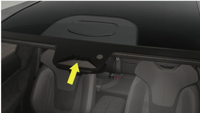
Lo schermo con microonde è fissato orizzontalmente al centro, in posizione verticale verso l'alto del parabrezza anteriore. Le informazioni sul veicolo sono memorizzate nello schermo con microonde. Tenere pulito il parabrezza anteriore per evitare che oggetti estranei blocchino lo schermo con microonde.
