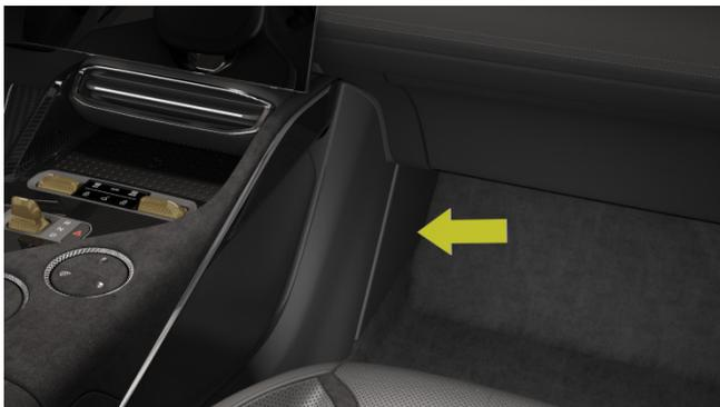
La scatola dei fusibili centrale si trova sul lato destro della console del tunnel, visibile rimuovendo la cornice anteriore destra della console del tunnel.
