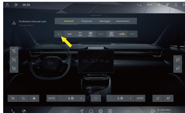
Fare clic su **TEMP** nel CSD per passare all'interfaccia del climatizzatore dove è possibile attivare o disattivare la funzione di sbrinamento/disappannamento dello specchio retrovisore per rimuovere pioggia, acqua nebulizzata o ghiaccio e neve.
