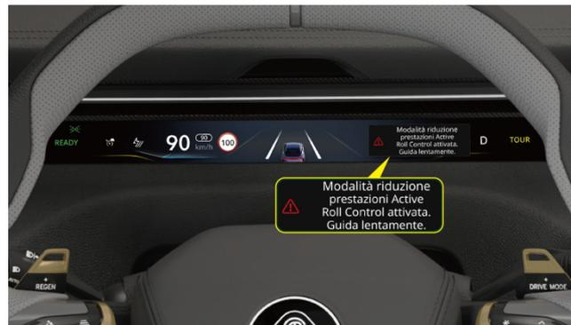
Quando sul quadro strumenti viene visualizzato un allarme di guasto relativo al sistema intelligente di controllo antirollio Lotus, non è consentito guidare su strade sconnesse e svoltare a bassa
