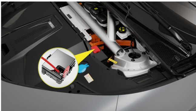
1. Parcheggiare il veicolo in un'area sicura e aprire il coperchio della scatola dei fusibili nel cofano del veicolo con la batteria scarica.
