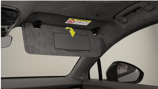
Abbassare l'aletta parasole per aprirlo e regolare l'angolazione secondo le necessità per bloccare il sole.
