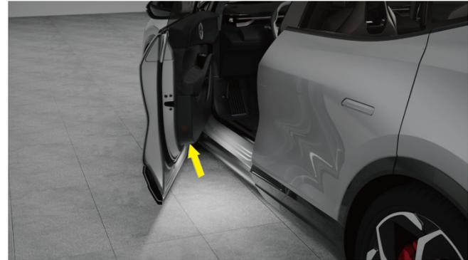
Quando l'ambiente esterno è poco illuminato, le luci a pavimento si accenderanno automaticamente all'apertura delle porte e si spengono automaticamente alla loro chiusura.
