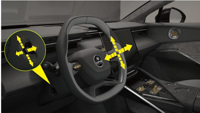
Quando il veicolo è acceso, è possibile regolare il volante dello sterzo verso l'alto, verso il basso, avanti e indietro tirando il pulsante di regolazione sul lato sinistro del piantone dello sterzo.
