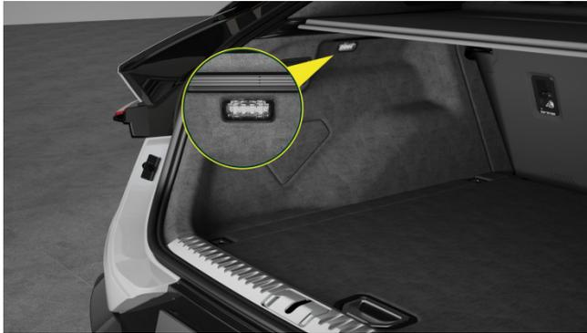
Quando si apre il portellone posteriore, la luce nel bagagliaio si accende automaticamente; quando si chiude il portellone posteriore, la luce nel bagagliaio si spegne automaticamente.
