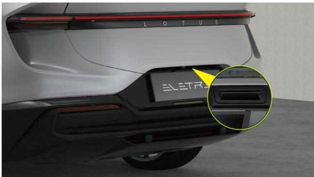
Sblocco di emergenza tramite interruttore di apertura del portellone posteriore
