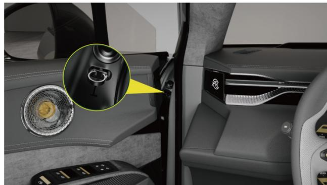
Il cavo di emergenza della serratura elettronica si trova sulla cerniera superiore della portiera del conducente.
