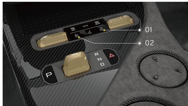
Serratura centralizzata nella parte anteriore della console del tunnel
