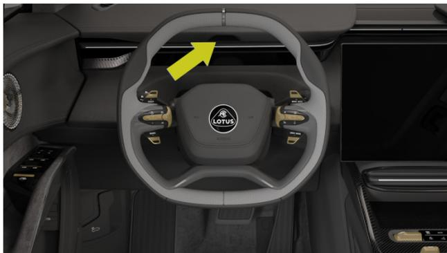
Telecamera di rilevamento della stanchezza del conducente
