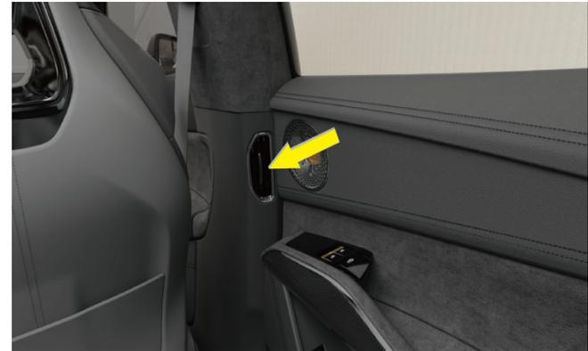
Uscita dell'aria laterale parte posteriore
