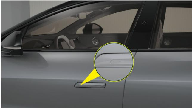
Quando la funzione di sblocco in avvicinamento è disattivata, portando con sé la chiave remota e toccando l'interruttore della maniglia della portiera del conducente è possibile bloccare o sbloccare il veicolo.
