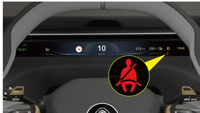
Se gli occupanti non indossano la cintura di sicurezza, vengono visualizzati un promemoria sul quadro strumenti e un messaggio sul CSD. Se tutte le cinture di sicurezza sono indossate correttamente ma il promemoria e l'allarme non si spengono, contatta il tuo rivenditore Lotus.
