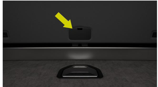
Sblocco di emergenza del coperchio di protezione del portellone posteriore
