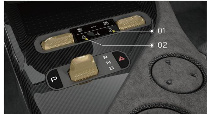
Serratura centrale sulla console del tunnel
