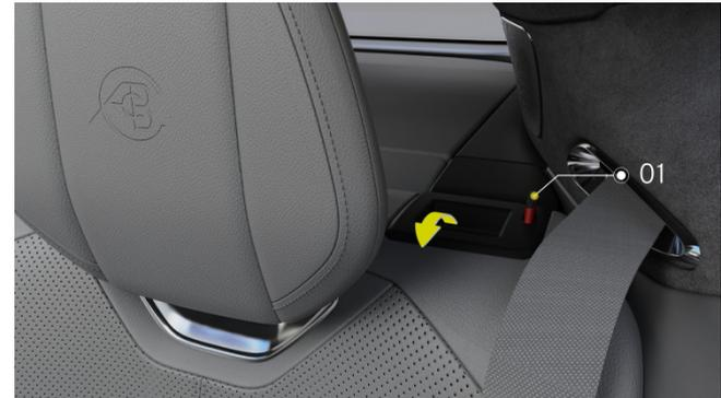
Il dispositivo di blocco si trova sul lato esterno del poggiatesta
