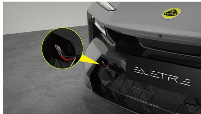
Sblocco di emergenza tramite alimentazione esterna
