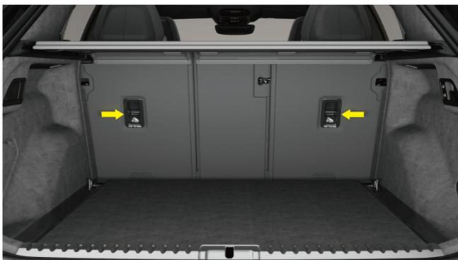
I punti di ancoraggio delle cinghie superiori del seggiolino di sicurezza per bambini si trovano dietro lo schienale del sedile posteriore.
