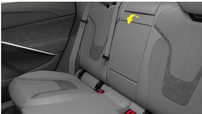
Al centro dello schienale del sedile posteriore è installato il bracciolo centrale, che può essere abbassato ed estratto per l'uso, e alzato e reinserto nello schienale per la chiusura.
