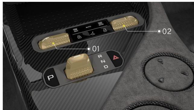
1. Interruttore di regolazione della temperatura lato conducente
