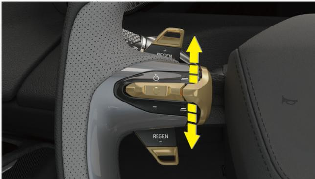
Alzare e abbassare il pulsante della distanza seguente: Posizionare il pollice sulla parte inferiore o superiore del pulsante della distanza successiva e spostare la manopola verso l'alto o verso il basso finché non si sente un suono nitido.
