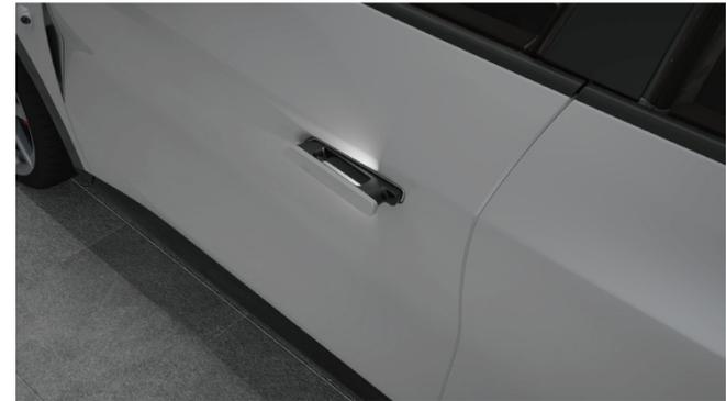
Quando la luce ambientale all'esterno del veicolo è insufficiente, la luce del manubrio si accende per illuminare l'interno della maniglia della porta per facilitare lo sblocco del veicolo e si spegne automaticamente dopo un certo periodo di tempo.
