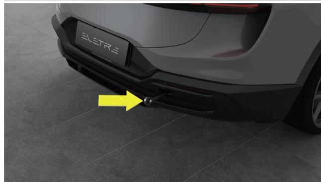
3. Avvitare l'occhiello di traino e continuare a stringere fino a quando l'occhiello di traino è completamente avvitato e il dispositivo di traino è fissato all'occhiello di traino.
