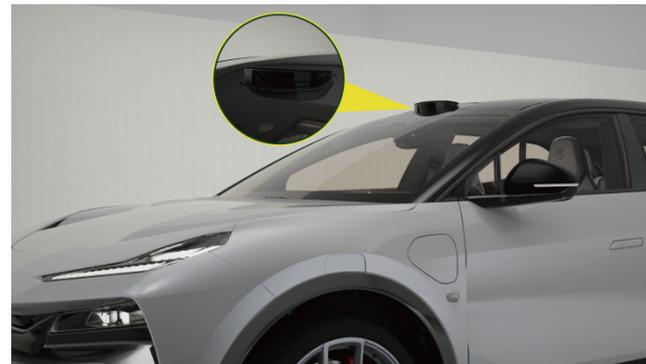
Aprire **Spettacolo di Benvenuto** ( p.113 )e quando il veicolo viene sbloccato, il LiDAR si aprirà e si chiuderà automaticamente.
