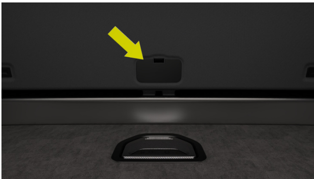
Nödöppning av bakluckans lock
