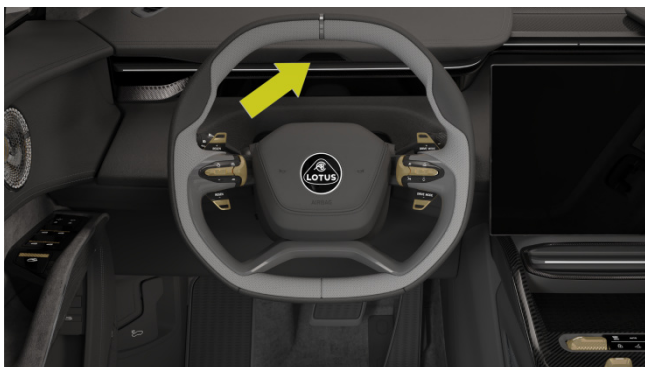
Kamera för detektering av förartrötthet.
