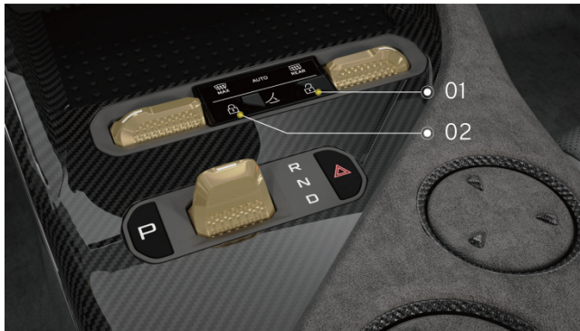
Centrallås på framsidan av tunnelkonsolen
