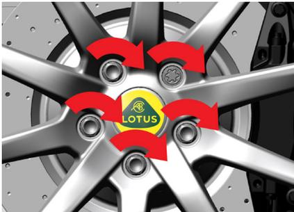
4. Ziehen Sie alle 5 Radschrauben kreuzweise mit der Standardverlängerung und (und dem kodierten Radschraubennadapter, wenn Sicherungsradschrauben montiert sind) an.
