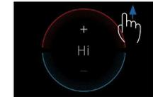
Drücken Sie und ziehen Sie außerhalb des Displays nach oben, um die „Hi“-Temperatur einzustellen.
