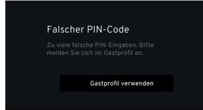
Ein Fahrerprofil wird nach 5 falschen Versuchen, einen PIN-Code einzugeben, deaktiviert. Wenn dies der Fall ist, tippen Sie auf die Schaltfläche „Gastprofil verwenden“.
