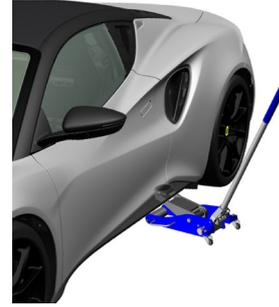
7. Setzen Sie einen geeigneten Wagenheber an den mit einem blauen Aufkleber gekennzeichneten hinteren Hebepunkt, siehe Seite 241 „Anheben des Fahrzeugs“. Dadurch werden beide Räder auf dieser Seite des Fahrzeugs angehoben.
