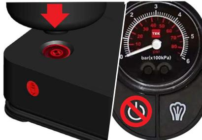
9. Drücken Sie die Reifendichtmittelflasche fest in die Öffnung des Kompressors.
