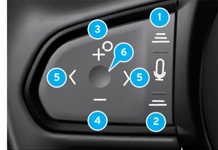
Der Tempomat und der adaptive Tempomat werden mit den Schaltern auf dem Tastenfeld auf der linken Seite des Lenkrads bedient.
