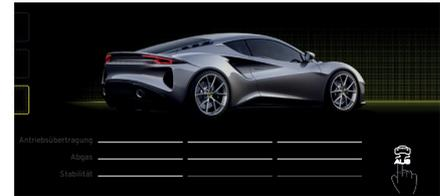
Alle Stabilitätsbalken erlöschen und zeigen damit an, dass ESC nicht verfügbar ist (mit Ausnahme der ABS- und HBA-Funktionen).
