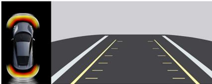
Der PAC wird bei jeder Geschwindigkeit automatisch aktiviert, wenn der Rückwärtsgang eingelegt wird, oder manuell über das mittlere Display.
