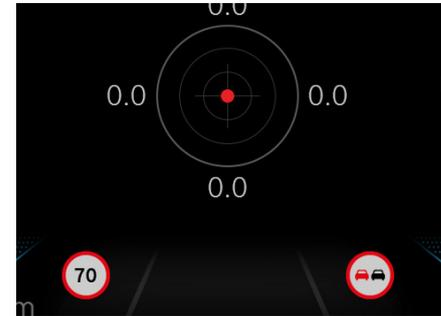
Ist die Verkehrszeichenerkennung aktiviert, wird beim Passieren eines erkennbaren Verkehrszeichens dieses als Symbol in der unteren Mitte des Fahrerdisplays angezeigt.
