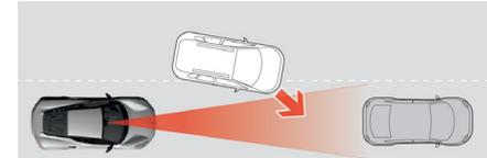
Das Radargerät erkennt möglicherweise zu spät Fahrzeuge in geringem Abstand, z. B. ein Fahrzeug, das zwischen Ihrem Fahrzeug und dem vorausfahrenden Fahrzeug fährt.
