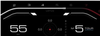
Steigt die Motordrehzahl im gleichen Gang weiter an, wird die zweite Schaltstufe erreicht und die äußeren Schaltblöcke leuchten auf.
