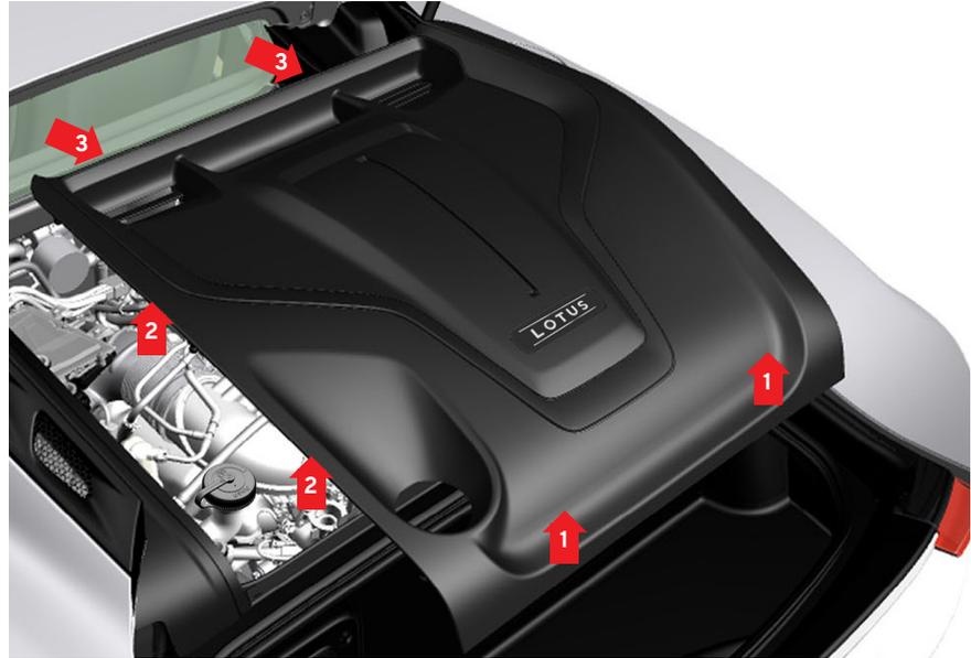
Prüfen Sie vor dem Schließen der Heckklappe, ob alle Verkleidungen des Motorraums korrekt angebracht und sicher sind.
