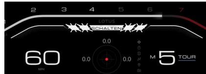
Die Leistungsschaltlinien und Schaltblöcke blinken langsam auf und **SCHALTEN** wird angezeigt, wenn die Motordrehzahl weiter ansteigt, um dem Fahrer zu signalisieren, dass der ideale Schaltpunkt nun erreicht ist.
