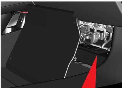
Die Bordwand ist eine Komponente des Insassenaufprallschutzes. Fahren Sie niemals mit dem Fahrzeug, wenn die Bordwand nicht korrekt installiert und angebracht ist.
