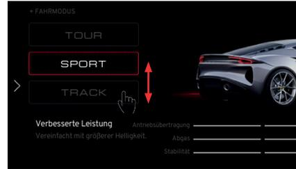
Bewegen Sie entweder den Fahrstufenwähler erneut nach vorne oder hinten, um zu einer neuen Fahrstufe zu wechseln, oder drücken Sie die Fahrstufentaste auf dem mittleren Display.
