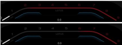
Die maximale Motordrehzahl wird während des Warmlaufens des Motors bis zum Erreichen der normalen Betriebstemperatur auf maximal 6.000 U/min abgestuft, wobei der geänderte maximale Drehzahlwert
