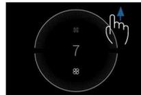
Drücken und ziehen Sie außerhalb des Displays, um die Gebläsestufe auf '7' einzustellen.
