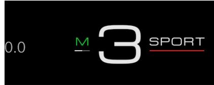
Wird ein Paddle nicht innerhalb von 20 Sekunden betätigt, kehrt das Getriebe in den Automatikmodus zurück und wählt den entsprechenden Gang, der sich von dem zuletzt manuell gewählten unterscheiden kann.
