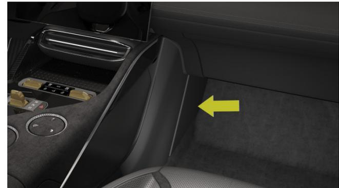
Der zentrale Sicherungskasten befindet sich an der rechten Seite der Tunnelkonsole. Der Zugang wird möglich, indem die Verkleidung der Tunnelkonsole rechts vorn abgenommen wird.
