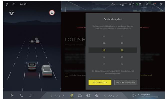
Sie können auch jederzeit innerhalb von 24 Stunden ein OTA-System-Upgrade planen. Sobald die Einstellung vorgenommen wurde, wird das Symbol für die geplante Aktualisierung oben rechts auf der Schnittstelle angezeigt. Das System startet die OTA-Aktualisierung automatisch zum geplanten Zeitpunkt, wenn eine Netzverbindung besteht.
