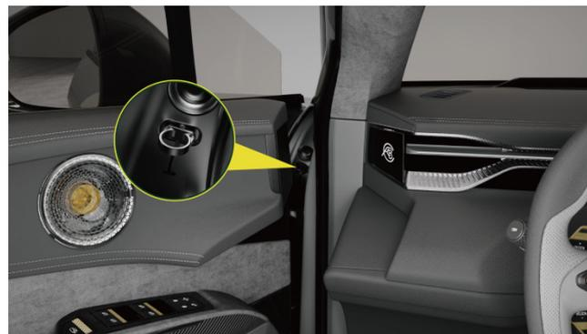
Das Seil für die Notöffnung des elektronischen Schlosses befindet sich am oberen Scharnier der Fahrertür.
