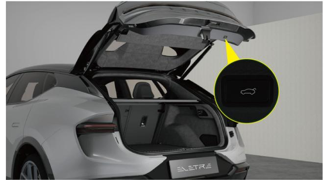
Schalter zum Schließen der Heckklappe
