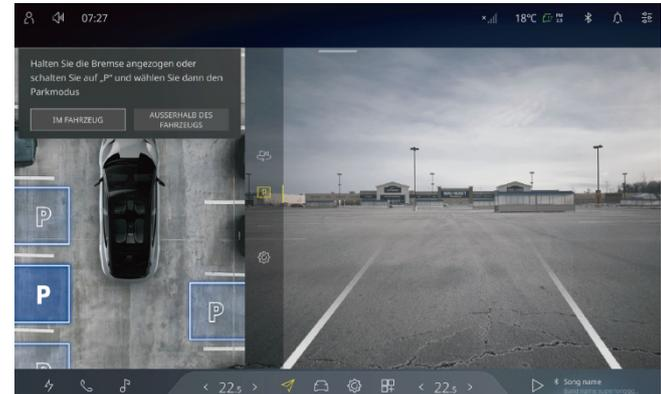
4. Befolgen Sie die Anweisungen zum Lösen des Bremspedals und zum Loslassen des Lenkrads und lassen Sie das Fahrzeug automatisch in die Parklücke fahren.
