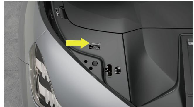
Etikettenposition für den Frontantriebmotor
