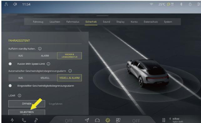
Wenn das Fahrzeug eingeschaltet ist und der Gangwählhebel in P-Gang ist, können Sie der vordere LiDAR bei Bedarf mit einem Tastendruck manuell gereinigt werden. Das LiDAR kann unter folgenden Bedingungen nicht manuell gereinigt werden:
