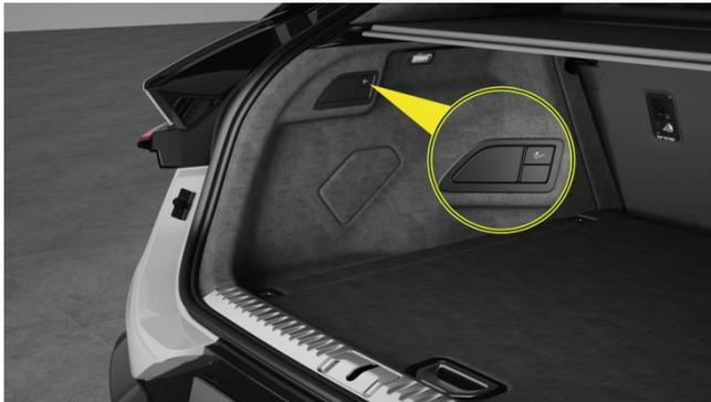
Schalter für die elektrische Anhängerkupplung
