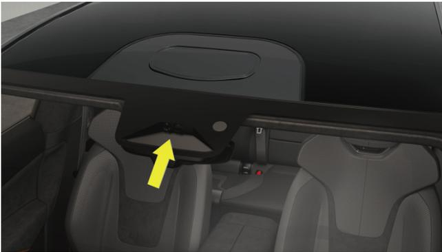
Das Mikrowellenfenster ist über der Mitte der Windschutzscheibe angebracht. Im Mikrowellenfenster sind Fahrzeugdaten gespeichert. Halten Sie die Windschutzscheibe sauber und achten Sie darauf, dass das Mikrowellenfenster nicht durch Fremdkörper blockiert wird.
