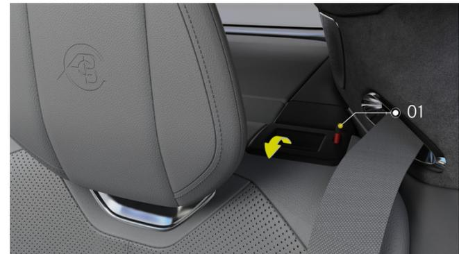
Die Verriegelung befindet sich an der Außenseite der Kopfstütze
