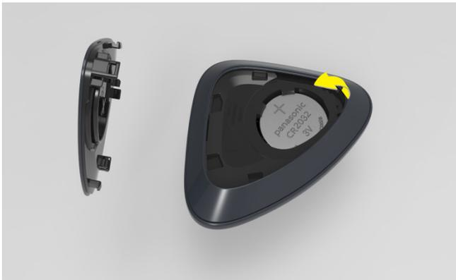
3. Stecken Sie das fingerhutähnliche Werkzeug (nicht mit dem Fahrzeug ausgestattet) in den Spalt, um die Batterie anzuheben. Der empfohlene neue Batterietyp ist: CR2032.
