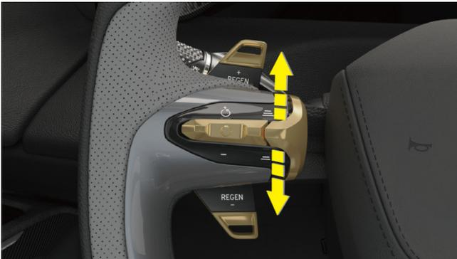
Schalten Sie die Taste für die folgende Entfernung nach oben oder unten: Legen Sie Ihren Daumen auf den unteren oder oberen Teil der Taste des Folgenabstandes und drehen Sie den Knopf nach oben oder unten, bis ein klarer Ton zu hören ist.
