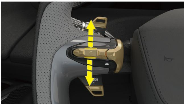
Schalten Sie die linke Multifunktionstaste nach oben und unten: Legen Sie Ihren Daumen in die Mitte des unteren oder oberen Teils der Multifunktionstaste und schalten Sie diese nach oben oder unten, bis ein klarer Ton zu hören ist.
