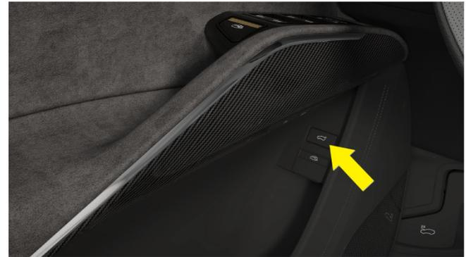
Heckklappenschalter an der Fahrertür
