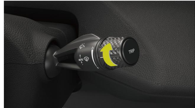
Die Empfindlichkeit des induzierten Regens kann durch Drehen des Empfindlichkeitsrads des RLSM nach oben und unten eingestellt werden. Je höher die Empfindlichkeit beim Drehen des Scrollrads
