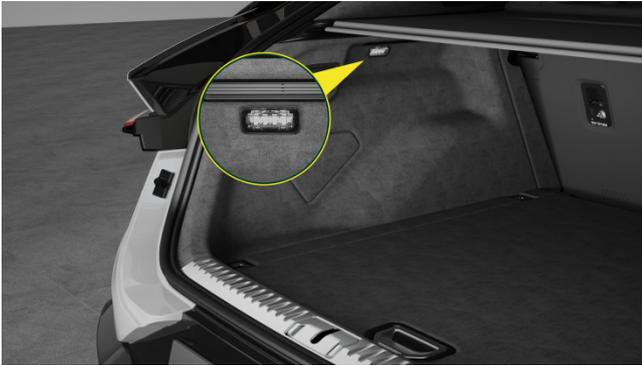
Wenn die Heckklappe geöffnet wird, schaltet sich das Licht im Kofferraum automatisch ein; beim Schließen der Heckklappe geht das Licht im Kofferraum automatisch aus.
