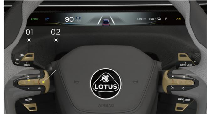
Einstellen der adaptiven Geschwindigkeitsregelung (ACC, Adaptive Cruise Control)
