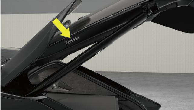
Etikettenposition für den Heckantriebsmotor
