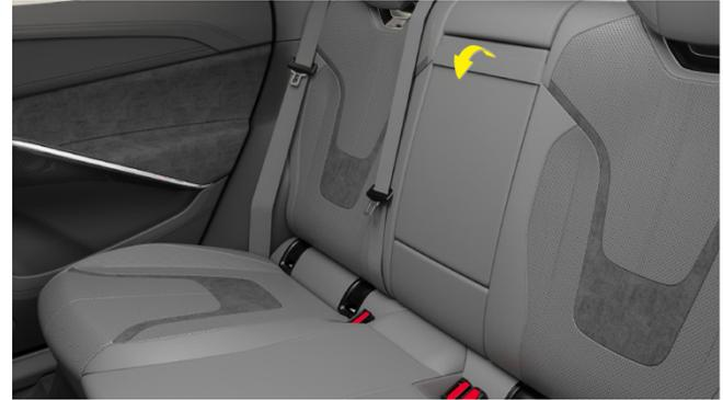
In der Mitte der Rück Sitzlehne befindet sich eine Mittelarmlehne, die zum Gebrauch heruntergeklappt und bis zum Gebrauch herausgezogen und zum Schließen hochgeklappt und in die Lehne zurückgedrückt werden kann.
