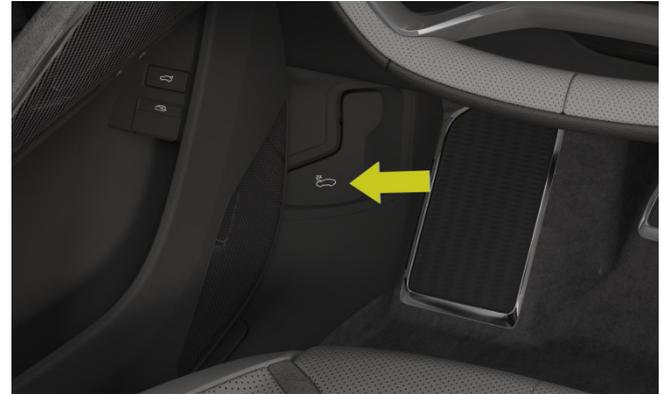
2. Ziehen Sie den Hebel zur Öffnung der Motorhaube zweimal hintereinander, um die Motorhaube zu entriegeln, und schließen Sie anschließend alle Türen und die Heckklappe.
