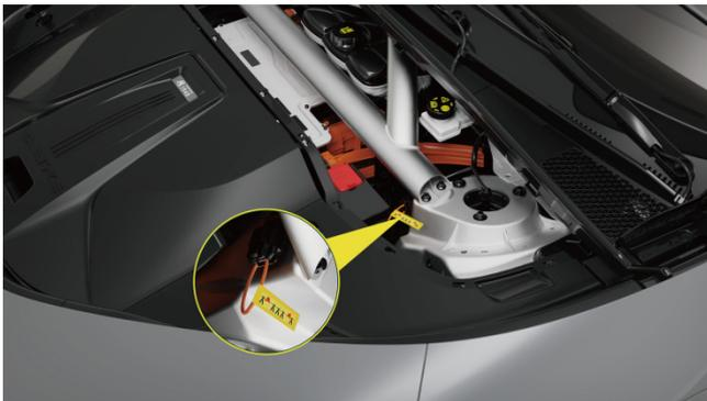
4. Lokalisieren Sie den MSD(Service-Trennschalter)-Stecker für Niederspannung und ziehen Sie ihn ab. Das Hochvoltssystem des Fahrzeugs wird dadurch deaktiviert.
