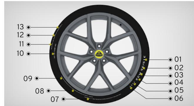
1. Breite des Reifens: Diese 3 Ziffern geben die Breite des Reifens von einer Seitenwand zur anderen Seitenwand an (in Millimetern).
