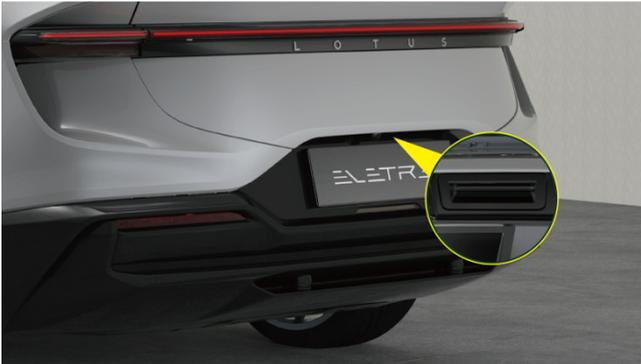
Schalter zum Öffnen der Heckklappe
