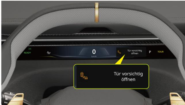
Wenn das DOW ein Ziel und eine Kollisionsgefahr beim Öffnen der Tür erkennt, leuchtet oder blinkt die Anzeige am Seitenspiegel, begleitet von einem akustischen Alarm und auf dem Kombiinstrument werden Bild- und Textalarmsignale angezeigt.
