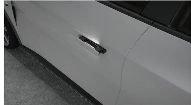
Wenn das Umgebungslicht außerhalb des Fahrzeugs nicht ausreicht, leuchtet die Lenkerleuchte auf, um die Innenseite des Türgriffs zu beleuchten, damit das Fahrzeug bequem entriegelt werden kann, und erlischt dann automatisch nach einer gewissen Zeit.
