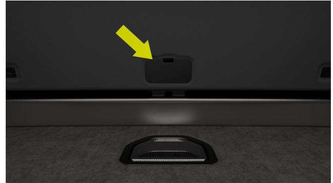
Notentriegelung der Schutzabdeckung der Heckklappe
