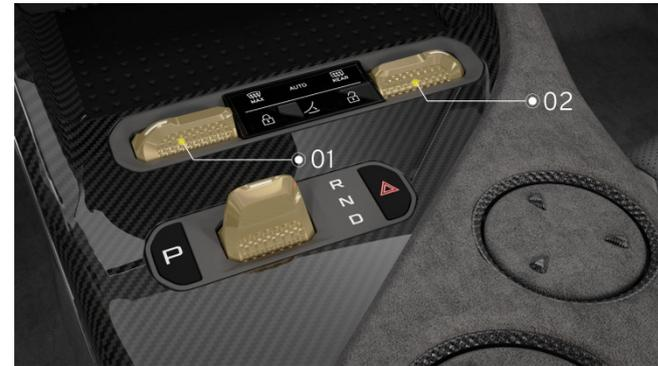
1. Schalter für die Temperatureinstellung auf der Fahrerseite
