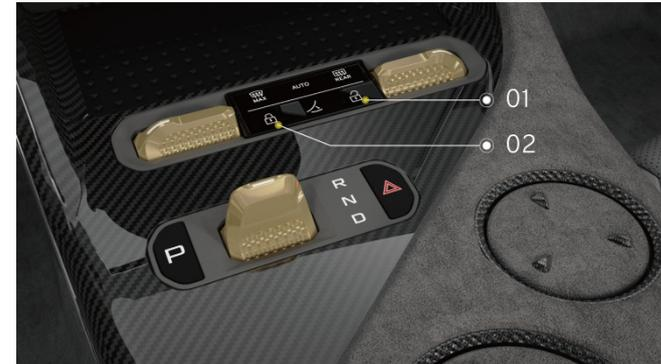
Zentralverriegelung an der Vorderseite der Tunnelkonsole
