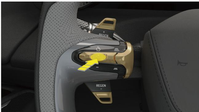
Drücken Sie die linke Multifunktionstaste: Legen Sie Ihren Daumen in die Mitte der Multifunktionstaste und drücken Sie die Taste, bis ein deutlicher Ton zu hören ist.
