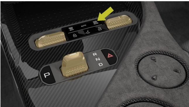
Seitenspiegelheizung über Frontkonsole
