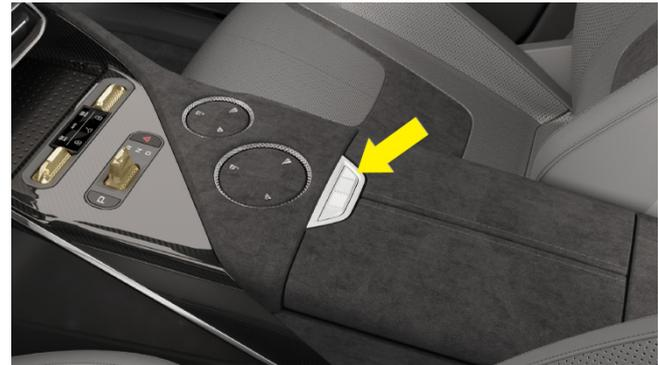
Öffnen/Schließen des Ablagefachs der Mittelarmlehne vorn
