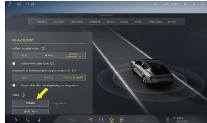
Wenn das Fahrzeug eingeschaltet ist und der Gangwählhebel in P-Gang steht, können Sie alle LiDAR-Sensoren bei Bedarf mit einem Tastendruck manuell aufklappen. Das LiDAR kann unter folgenden Bedingungen nicht manuell aktiviert werden:
