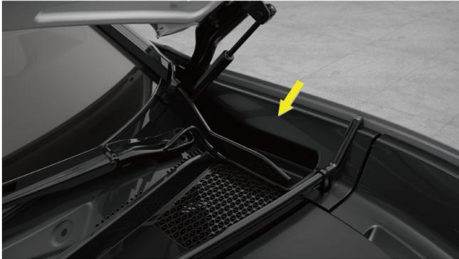
3. Drücken Sie den Verriegelungshebel der Ladeanschlussabdeckung nach hinten, um die Ladeanschlussabdeckung zu entriegeln. Ziehen Sie die Ladeanschlussabdeckung dann zum Öffnen aus dem Spalt.
