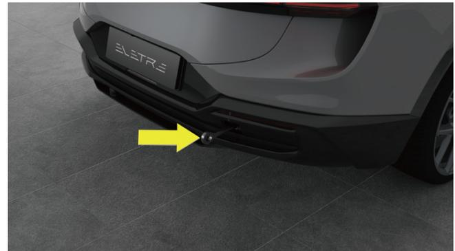
3. Schrauben Sie den Abschleppöse ein und ziehen Sie sie weiter an, bis die Abschleppöse vollständig eingeschraubt ist und die Abschleppvorrichtung an der Abschleppöse befestigt ist.
