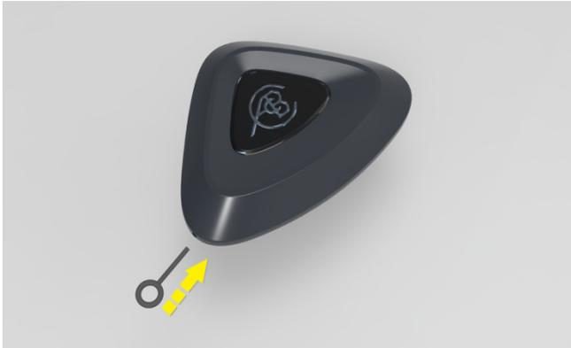
2. Entfernen Sie die Abdeckung auf der Rückseite des Schlüssels.
