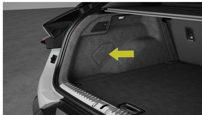
Entfernen Sie das Lagerfach im Kofferraum, um an den Sicherungskasten hinten zu gelangen.
