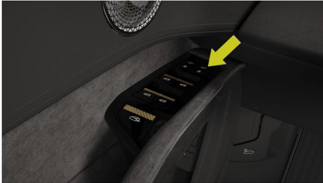
Schalter zum Umklappen der Seitenspiegel
