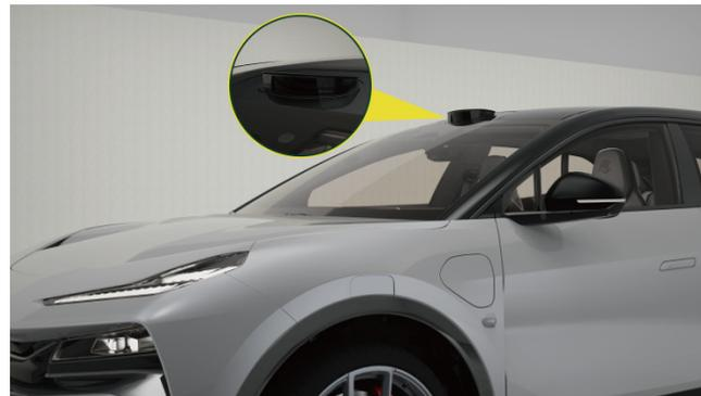
Öffnen Sie **Begrüßungs-Show** ( p.113 ) Und wenn das Fahrzeug entriegelt wird, wird sich das LiDAR automatisch entfalten und zusammenklappen.
