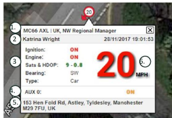
Anzahl der Satelliten und HDOP (Horizontal Dilution of Precision). Für eine Fixierung sind mindestens 3 Satelliten erforderlich. HDOP ist ein Maß für die geometrische Qualität der Satellitenkonfiguration am Himmel. HDOP ist ein Faktor zur Bestimmung der relativen Genauigkeit einer horizontalen Position. Je kleiner die DOP-Zahl ist, desto besser ist die Genauigkeit. Ein HDOP-Wert für eine gute 3D-Fixierung sollte immer unter 2,0 liegen.
