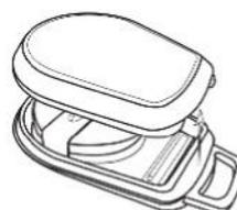
2. Saque de la carcasa la placa de circuito (donde se aloja la pila) para poder acceder a la pila
