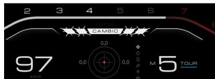
Le linee e i blocchetti di cambio Performance cominciano a lampeggiare lentamente e viene visualizzato **CAMBIO** mentre il regime del motore continua ad aumentare, indicando al conducente che è stato raggiunto il punto di cambio ideale.
