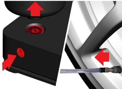
17. Scollegare il connettore del compressore dalla presa di corrente ausiliaria da 12 V, premere il pulsante sul lato del compressore per staccare la bomboletta di sigillante per pneumatici e riapplicare il cappuccio della valvola del pneumatico.
