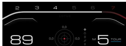
Il continuo incremento di regime senza alcun passaggio di marcia fa illuminare i blocchetti interni, indicanti il terzo livello di cambiata.
