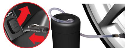
11. Posizionare il compressore vicino al pneumatico, assicurandosi che la bomboletta di sigillante sia in posizione verticale.
