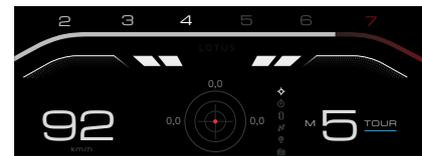
Se l'indicazione di cambio marcia viene ignorata e il regime del motore supera il punto di cambiata finale, le linee e i blocchetti iniziano a lampeggiare più velocemente.
