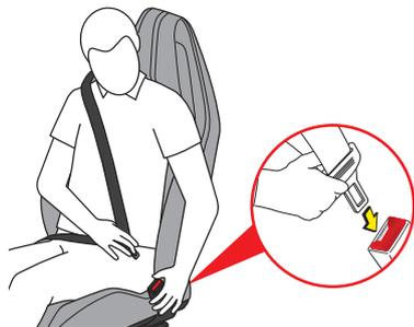
1. Sedersi in posizione eretta con la schiena completamente aderente allo schienale. Afferrare la linguetta della cintura di sicurezza e tirarla per estrarre la cintura dal riavvolgitore.
