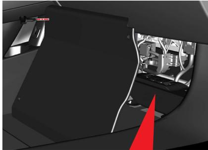
Il pannello della pedana è uno dei componenti di protezione degli occupanti contro gli urti. Non guidare mai il veicolo senza che il pannello della pedana sia stato installato e montato correttamente.
