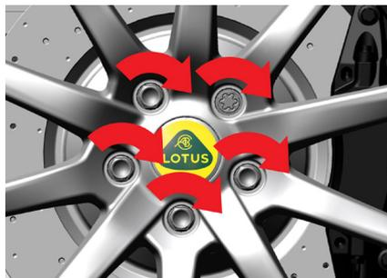
5. Serrare tutti e 5 i bulloni con schema incrociato utilizzando la prolunga standard (e l'adattatore codificato in caso di utilizzo di bulloni di bloccaggio).
