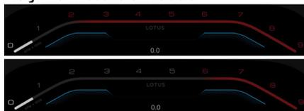
In fase di riscaldamento del motore, il regime massimo è graduato a 6.000 giri/min fino al raggiungimento della normale temperatura di esercizio; durante il riscaldamento, nella zona
