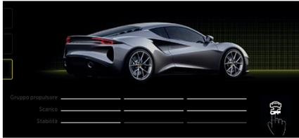
Tutte le barre indicanti il livello di stabilità si spengono, a segnalare che il sistema ESC non è disponibile (ad eccezione delle funzioni ABS e HBA).
