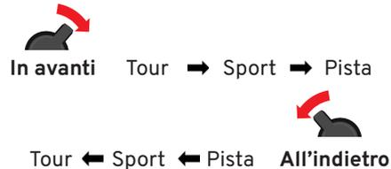
Spostare l'interruttore una volta per visualizzare la modalità di guida al momento in uso nella schermata a comparsa che si apre sul display centrale.
