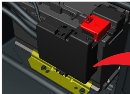
**⚠ AVVERTENZA:** nel caso in cui il terminale di un fusibile mega venga inavvertitamente collegato a terra (ad esempio, quando si utilizza una chiave inglese) mentre il terminale negativo della batteria è ancora collegato, il cortocircuito risultante, con forti scintille e flusso di corrente, potrebbe causare gravi ustioni e/o un incendio.
