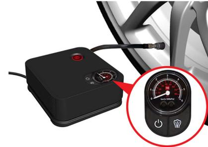
21. Estrarre il kit e ricollegare il connettore elettrico del compressore alla presa di corrente da 12 V del veicolo, assicurandosi che il pulsante di accensione sia impostato su off.
