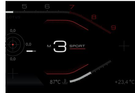
Il mancato azionamento di una delle due leve al volante entro un intervallo di 20 secondi determina il ritorno alla modalità automatica con selezione di una marcia appropriata, che potrà essere diversa dall'ultima marcia selezionata manualmente.
