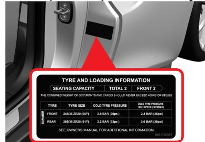
La pressione dei pneumatici a freddo deve essere controllata ogni settimana o ogni 1.600 km, a seconda di quale delle due condizioni si verifichi per prima, con successiva regolazione qualora necessario.
