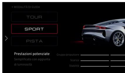
Compare una descrizione delle caratteristiche di guida della modalità selezionata, oltre ai livelli di propulsione, sonorità scarico e intervento del controllo elettronico di stabilità, rappresentati sotto forma di barre luminose nella parte inferiore della schermata.
