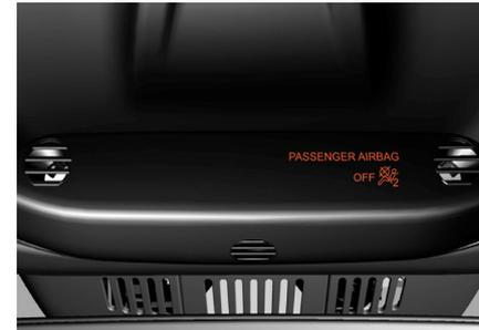
Anche la console superiore mostra un messaggio e un simbolo indicanti che l'airbag del passeggero è disattivato.
