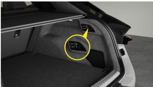
Interrupteur de réglage de la suspension du coffre
