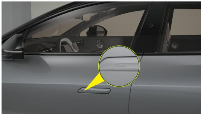
Une fois la fonction de déverrouillage de la porte désactivée, le fait de porter la clé physique UWB et de toucher l'interrupteur de la poignée de la porte conducteur peut verrouiller ou déverrouiller le véhicule.
