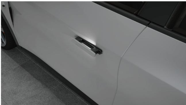
Lorsque la lumière ambiante à l'extérieur du véhicule est insuffisante, la lumière du guidon s'allumera pour éclairer l'intérieur de la poignée de la porte afin de faciliter le déverrouillage du véhicule, puis s'éteindra automatiquement après un certain temps.
