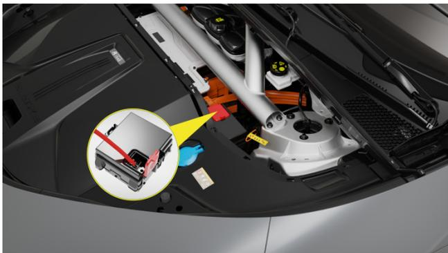
1. Garer le véhicule dans un endroit sûr et ouvrir le couvercle de la boîte à fusibles dans le capot du véhicule dont la batterie est déchargée.
