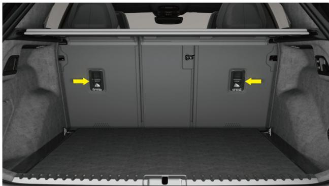
Les ancrages de l'attache supérieure du siège de sécurité pour enfants sont situés derrière le dossier du siège arrière.
