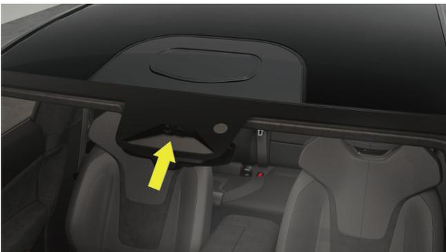
La fenêtre hyperfréquence est fixée horizontalement au centre, en position verticale vers le haut du pare-brise avant. Les informations sur le véhicule sont stockées dans la fenêtre hyperfréquence. Garder le pare-brise avant propre et empêcher les objets étrangers de bloquer la fenêtre hyperfréquence.
