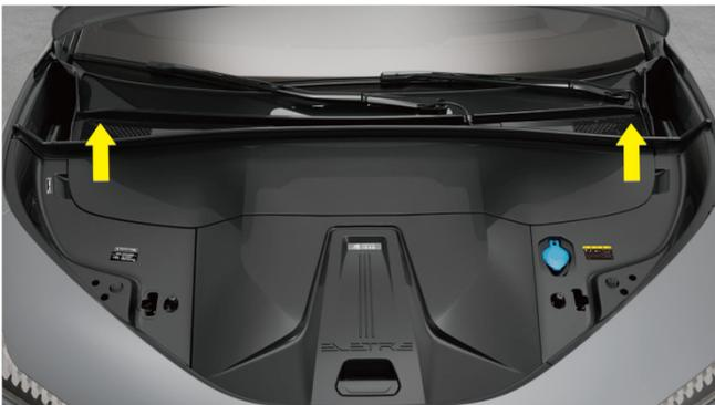
Des feuilles et des insectes peuvent s'accumuler dans les événements extérieurs de la climatisation, dans la grille sous l'arrière du capot, veuillez donc les nettoyer régulièrement pour éviter les blocages.
