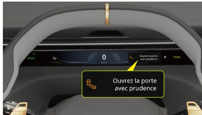
Si DOW détecte une cible et qu'il y a un risque de collision lors de l'ouverture de la porte, l'indicateur sur le rétroviseur extérieur s'allume ou clignote, accompagné d'une alarme sonore, et des images et des signaux d'alarme textuels s'affichent sur le groupe d'instruments.
