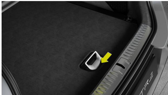
Une boîte de rangement du coffre est fournie sous le plancher du coffre, qui peut être utilisée pour ranger les outils du conducteur.
