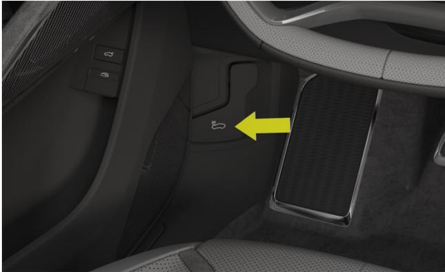
2. Tirez successivement deux fois sur la poignée d'ouverture du capot pour déverrouiller le capot et fermer toutes les portes et le hayon.
