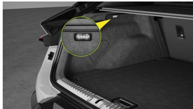
Lorsque le hayon est ouvert, la lumière dans le coffre s'allumera automatiquement ; lorsque le hayon est fermé, la lumière dans le coffre s'éteindra automatiquement.
