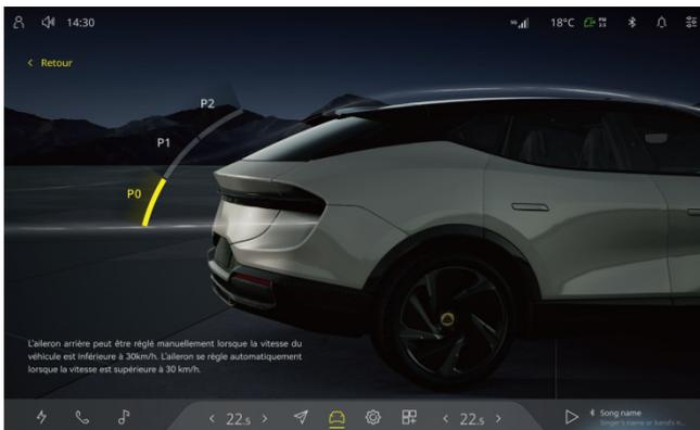
Vous pouvez régler manuellement l'aile de queue actif en cliquant sur les différents engrenages.
