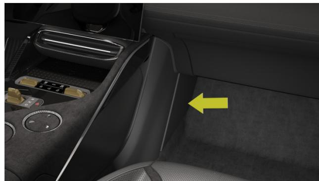
La boîte à fusibles centrale est située sur le côté droit de la console du tunnel, visible en retirant le cache avant droit de la console du tunnel.
