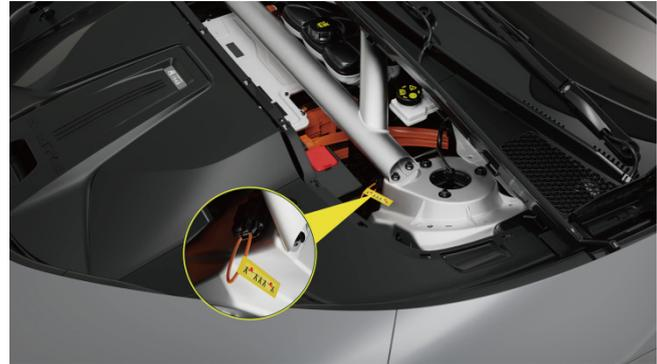
4. Trouver le sélectionneur de service manuel (MSD) basse tension dans le capot et le retirer, et le véhicule désactive automatiquement le système haute tension.
