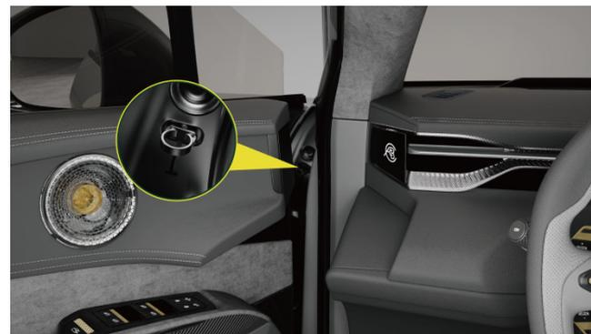
La corde d'urgence de la serrure électronique est placée à la charnière supérieure de la porte du conducteur.
