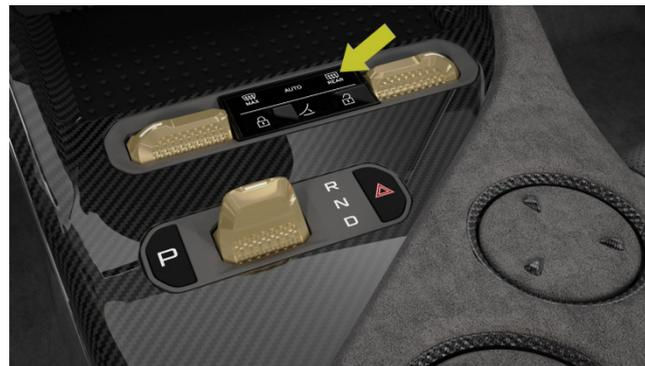
Chauffage des rétroviseurs extérieurs via la console avant
