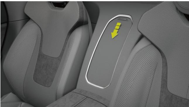
La poche du dossier du siège arrière est située au centre du dossier du siège arrière et est enfoncée jusqu'au verrou inférieur ; elle se referme automatiquement lorsqu'elle est appuyée à nouveau.
