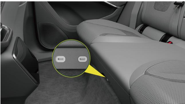
Il y a deux ports USB-C en bas au centre de l'assise de siège arrière, qui peuvent être utilisés par les passagers pour le chargement.
