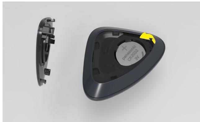
3. Utilisez l'outil de type dé à coudre (non inclus dans le véhicule) pour insérer l'espace afin de soulever la batterie. Le nouveau type de batterie recommandé est de : CR2032.
