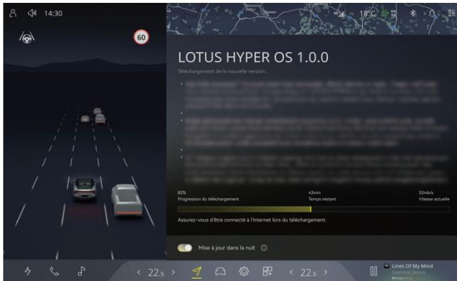
Vous pouvez ouvrir l'interface de mise à niveau du système OTA en cliquant sur ↓ l'icône en haut de l'affichage central ou en cliquant sur ⚙️ l'icône et en sélectionnant **Système - Vérifier la mise à jour** dans l'interface de réglage. Le champ d'informations de mise à jour affiche le but, les éléments, le temps estimé requis pour la mise à niveau, l'impact de la mise à niveau sur les fonctions du véhicule et toutes les notes relatives à la mise à niveau.
