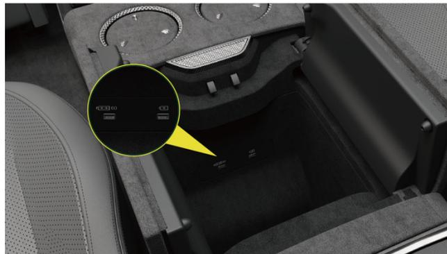
Il y a deux ports USB-C dans la boîte d'accoudoir central arrière, qui peuvent être utilisés par les passagers pour la charge.
