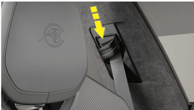
Appuyez sur l'interrupteur de relâchement et maintenez-le enfoncé pour déplacer le dispositif de réglage de la hauteur de l'épaule de la ceinture de sécurité vers le haut et vers le bas, qui peut être réglé dans la position appropriée selon vos besoins afin que la ceinture de sécurité puisse mieux s'adapter à l'épaule.
