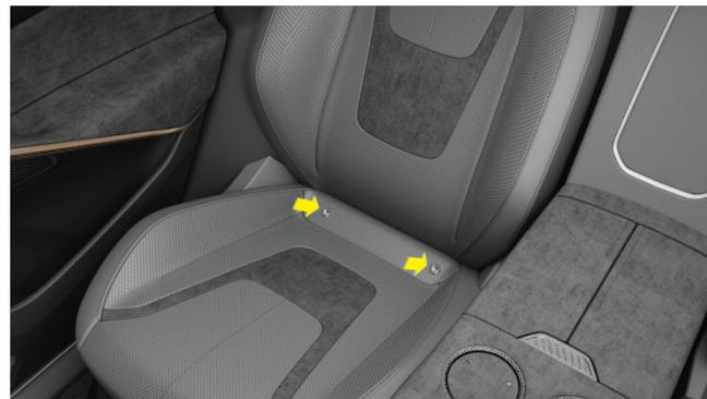
Les ancrages I-Size sont situés dans les deux sièges arrière extérieurs, et le logo I-Size est imprimé sur le couvercle des ancrages.
