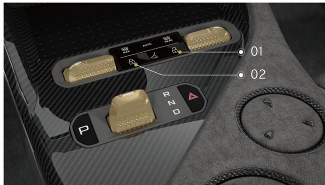
Verrouillage central à l'avant de la console du tunnel
