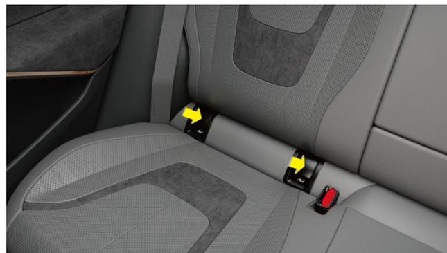
Les ancrages I-Size sont situés dans les deux sièges extérieurs arrière, et le logo I-Size est imprimé sur les points de connexion des ancrages.
