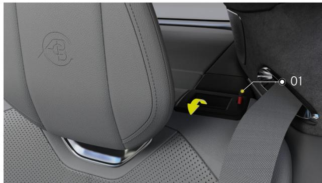
Le dispositif de verrouillage est situé sur le côté extérieur de l'appui-tête
