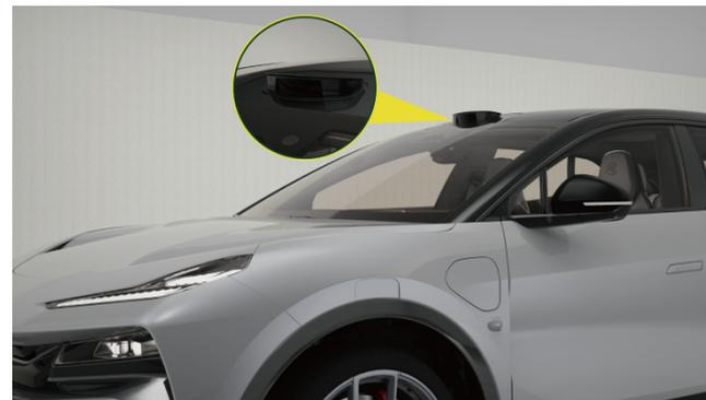
Spectacle de bienvenue **Ouvrez le** ( p.113 ) et lorsque le véhicule est déverrouillé, le LiDAR se déploiera et se repliera automatiquement.
