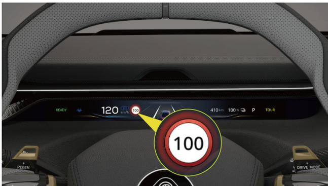
L'alarme se déclenche lorsque la vitesse du véhicule dépasse la limitation de vitesse reconnue par le système ; L'alarme se déclenche lorsque la vitesse du véhicule est inférieure à la limitation de vitesse reconnue par le système jusqu'à ce qu'une nouvelle limitation de vitesse soit détectée.
