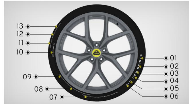
1. Largeur du pneu : Ces 3 chiffres représentent la largeur du pneu d'un flanc à l'autre (en millimètres).
