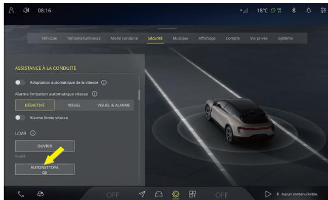
Lorsque le véhicule est sous tension et que le levier de vitesse est en position P, le LiDAR avant peut être nettoyé manuellement par simple pression, selon les besoins. Le LiDAR ne peut pas être nettoyé manuellement dans l'une des conditions suivantes :
