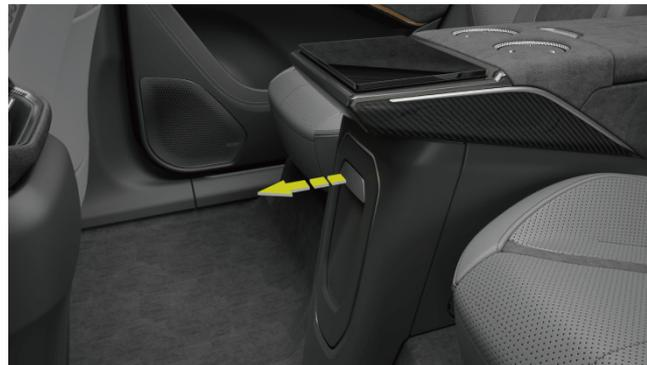
La poche de la console du tunnel arrière est située sous l'accoudoir central du siège arrière, qui peut être ouverte en la tirant vers l'extérieur.
