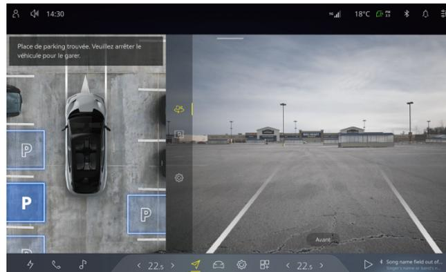
3. Lorsqu'une place de stationnement disponible est détectée, appuyer sur la pédale de frein pour arrêter le véhicule de manière stable. Le conducteur peut sortir du véhicule avec une clé et un téléphone valides après avoir cliqué sur le bouton **STATIONNEMENT À DISTANCE**.
