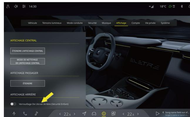
Après l'activation de la **fonction de Verrouillage de l'affichage arrière**, le fait d'appuyer sur l'affichage arrière allumera brièvement l'écran, où la méthode de réouverture de l'affichage arrière s'affichera. Si vous ne l'utilisez pas pendant un certain temps, l'affichage arrière se verrouillera automatiquement.
