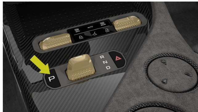
Une fois le véhicule garé, appuyez sur le bouton P, la vitesse passe en P et le frein de stationnement électronique est activé automatiquement.
