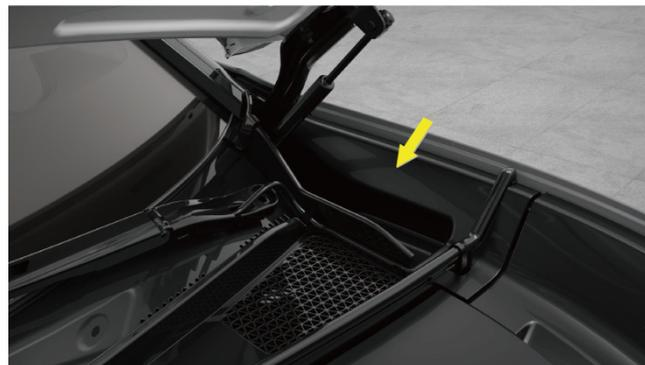
3. Poussez le levier de verrouillage du couvercle du port de recharge vers l'arrière pour déverrouiller le couvercle du port de recharge, puis le retirer de l'espace et ouvrir le couvercle du port de recharge.
