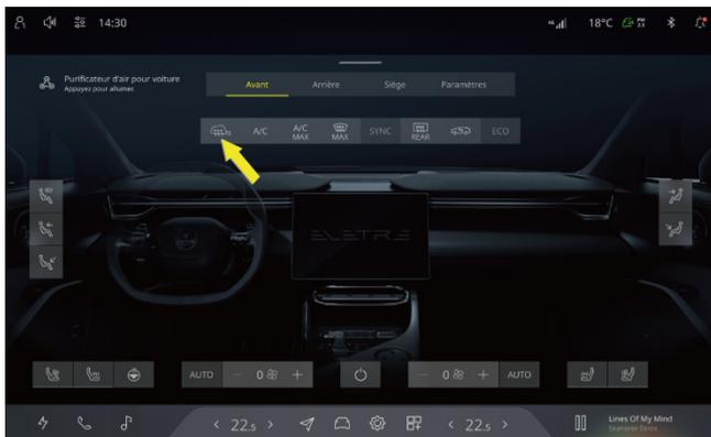
Cliquez sur **TEMP** sur le CSD pour passer à l'interface de commande de la climatisation où vous pouvez activer ou désactiver la fonction de dégivrage/désembuage du rétroviseur en continu pour éliminer la pluie, le brouillard d'eau ou la glace et la neige de la caméra.
