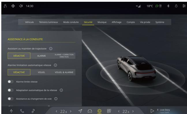
Cette interface permet de régler l'assistance à la conduite, la sécurité active et la sécurité du passager.
