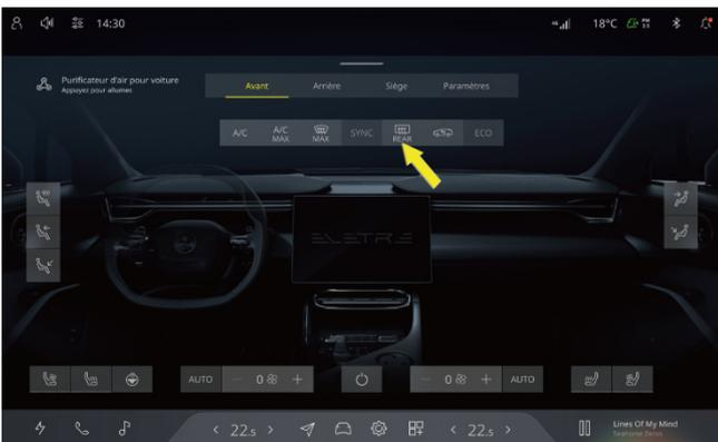
Chauffage des rétroviseurs extérieurs via le CSD
