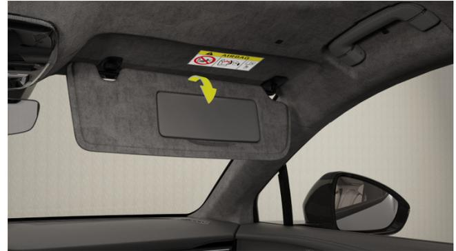
Abaisser le pare-soleil pour l'ouvrir et ajuster l'angle au besoin pour bloquer le soleil.
