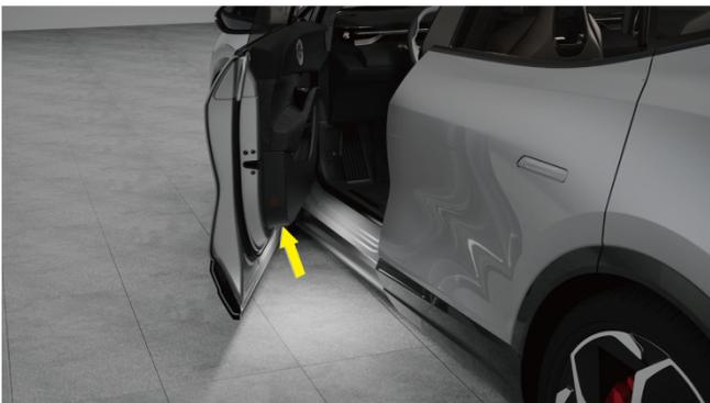
Lorsque l'environnement extérieur est sombre, les lumières au sol s'allument automatiquement à l'ouverture des portes et s'éteignent automatiquement à la fermeture des portes.
