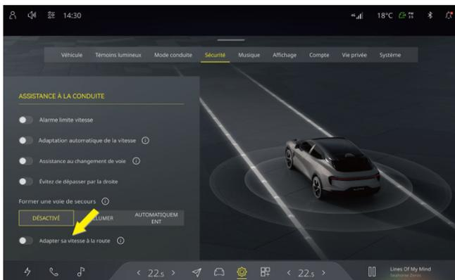
Cliquez sur l'icône ⚙️ sur le CSD et sélectionnez **Sécurité** pour entrer dans l'interface de réglage de l'assistance à la conduite, activer ou désactiver le réglage de la vitesse à l'itinéraire.
