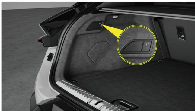
Interrupteur du crochet de remorquage électrique
