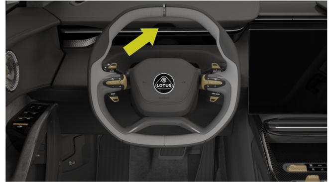
Caméra de détection de la fatigue du conducteur
