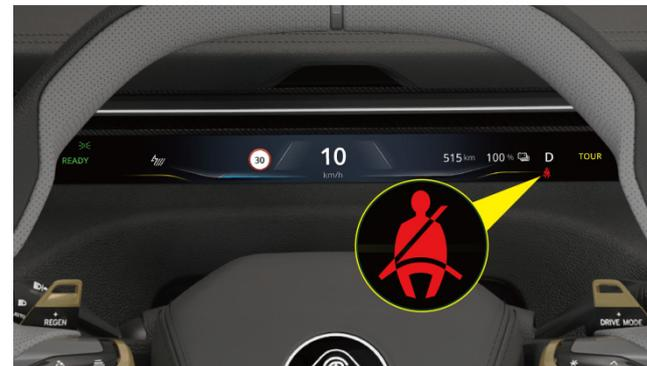
Le rappel sur l'affichage de l'instrument et un message pertinent dans le CSD alertent les occupants non attachés de porter leur ceinture de sécurité. Si toutes les ceintures de sécurité sont correctement attachées mais que le rappel et l'alarme ne s'éteignent pas, contactez votre détaillant Lotus.
