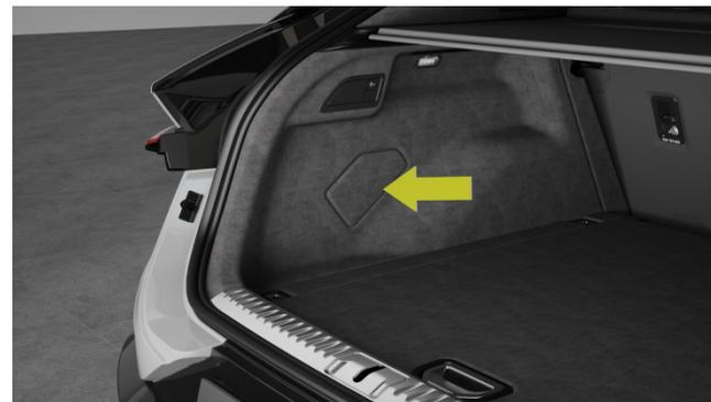
Retirez le coffre de rangement du coffre pour trouver la boîte à fusibles électrique arrière.
