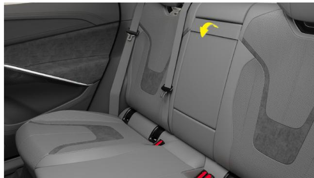
L'accoudoir central est monté au milieu du dossier du siège arrière et peut être abaissé et tiré pour être utilisé, puis relevé et repoussé dans le dossier pour être refermé.
