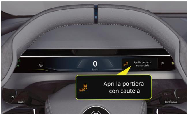
Se il sistema DOW rileva un target e sussiste il rischio di collisione durante l'apertura della portiera, l'indicatore sullo specchietto retrovisore esterno si illuminerà o lampeggerà, accompagnato da un allarme acustico, e sul quadro strumenti compariranno immagini e segnali di allarme testuali.
