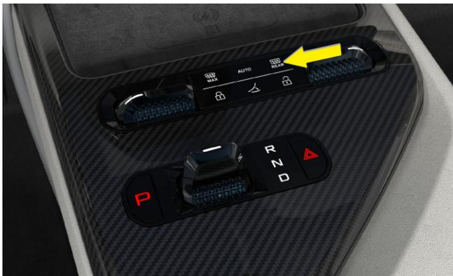
Riscaldamento dello specchietto retrovisore laterale esterno tramite la console del tunnel
