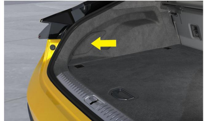
Rimuovere il pannello di rivestimento sinistro del bagagliaio per trovare la scatola dei fusibili posteriore.
