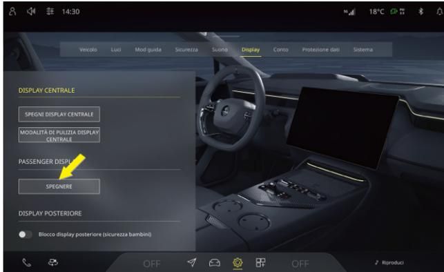
Una volta acceso il veicolo, è possibile toccare l'interruttore di spegnimento dello schermo o un punto qualsiasi dello schermo, in base alle necessità, per disattivare o attivare lo schermo del passeggero. È possibile anche fare clic sull'icona nel CSD, selezionare **Display** e fare clic su **ATTIVA o DISATTIVA** in questa interfaccia per attivare o disattivare lo schermo lato passeggero.
