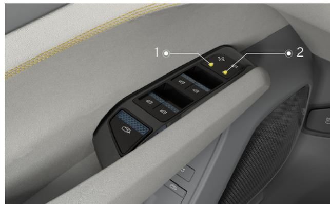
1. Interruttore di blocco di sicurezza per bambini sulla porta posteriore sinistra del conducente
