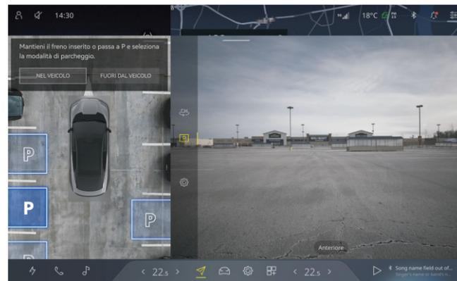
4. Quando si rilascia il pedale del freno e il volante come richiesto, il veicolo si avvia automaticamente verso il parcheggio.
