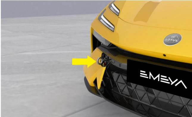
Foro di montaggio dell'anello di traino del paraurti anteriore
