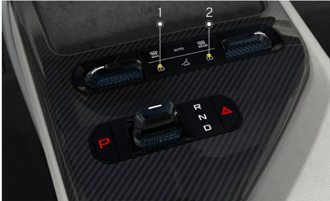
Serratura centrale sulla console del tunnel
