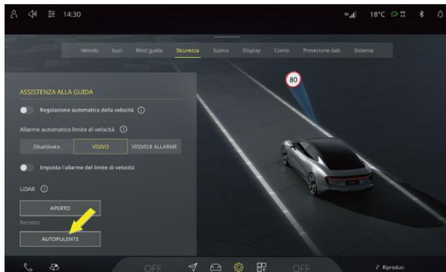
Quando il veicolo è acceso e la leva del cambio è spostata in posizione P, tutti i lidar possono essere puliti manualmente con un solo tocco, a seconda delle necessità. Il lidar non può essere pulito manualmente in nessuna delle seguenti condizioni:
