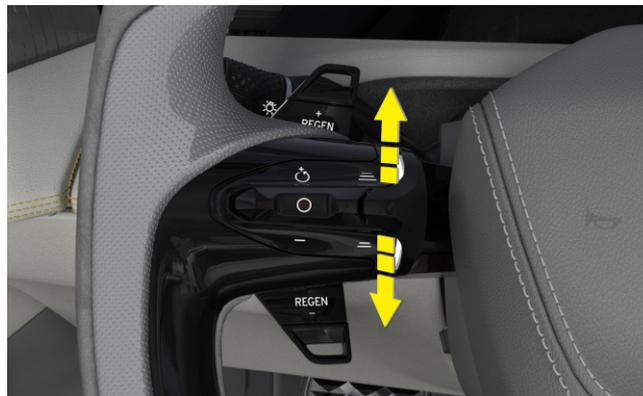
Alzare e abbassare il pulsante della distanza seguente: Posizionare il pollice sulla parte inferiore o superiore del pulsante della distanza seguente e spostare la manopola verso l'alto o verso il basso finché non si sente un suono nitido.
