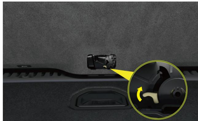
Sblocco di emergenza della leva di comando del portellone posteriore
