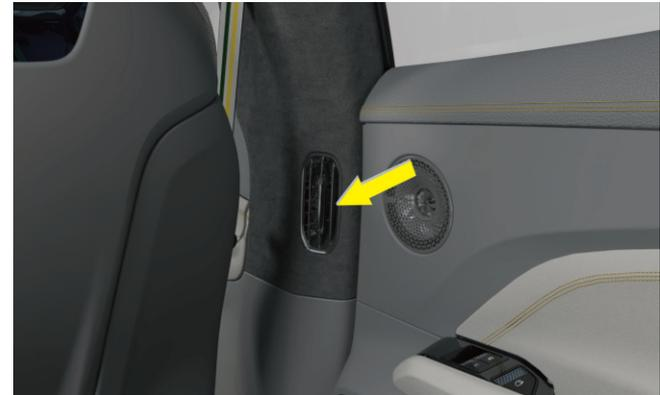
Uscita dell'aria laterale parte posteriore
