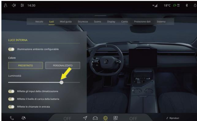
È possibile trascinare il cursore in un punto qualsiasi del cursore di regolazione della luminosità per impostare la luminosità della lampada ambientale.
