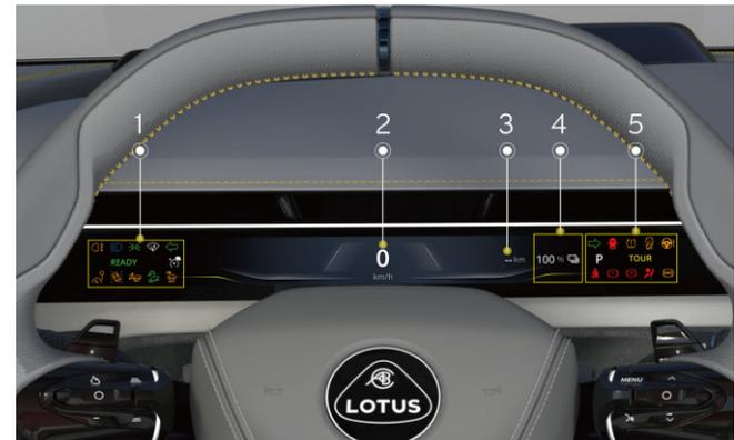
1. Area di display dell'indicatore sinistro: Visualizza informazioni rilevanti come lo stato delle luci esterne e il sistema di assistenza del conducente.
