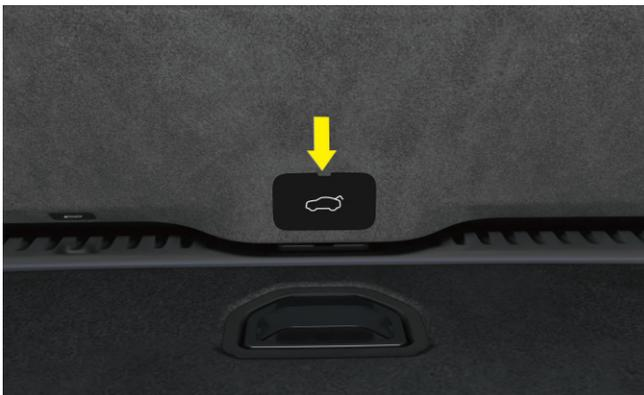
Sblocco di emergenza del coperchio di protezione del portellone posteriore
