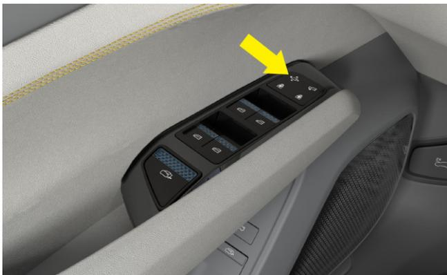
Interruttore di regolazione dello specchietto retrovisore laterale esterno
