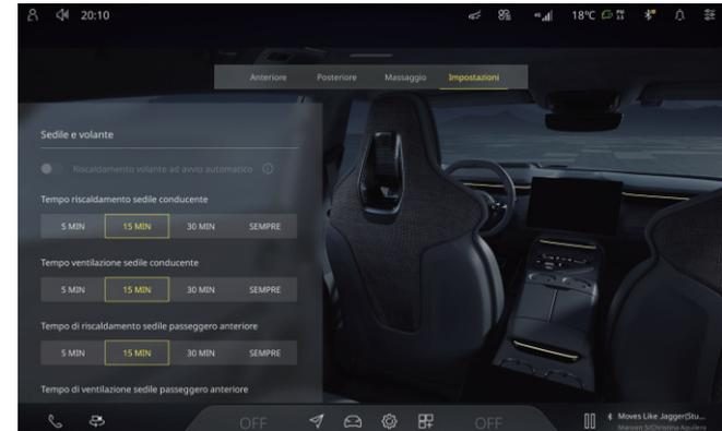
Toccare **Impostazioni** nell'interfaccia di controllo A/C sul CSD per passare all'interfaccia di impostazione del riscaldamento del sedile anteriore.
