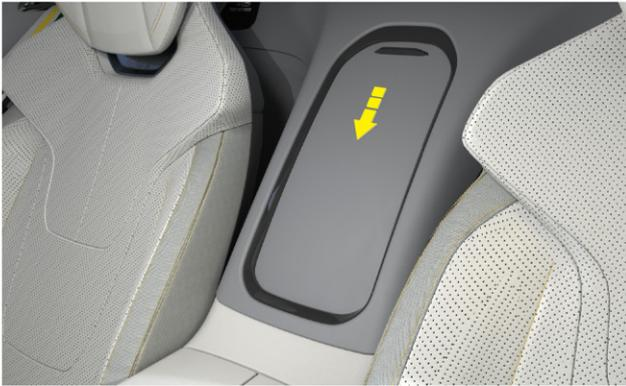
La tasca sullo schienale del sedile posteriore si trova al centro dello schienale del sedile posteriore, può essere bloccata se viene spinta fino in fondo e si chiude automaticamente se viene nuovamente premuta.
