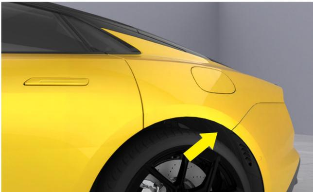
2. Spingere all'indietro la leva di blocco del coperchio della porta di ricarica per sbloccarlo, estrarlo dalla fessura e aprire il coperchio della porta di ricarica.
