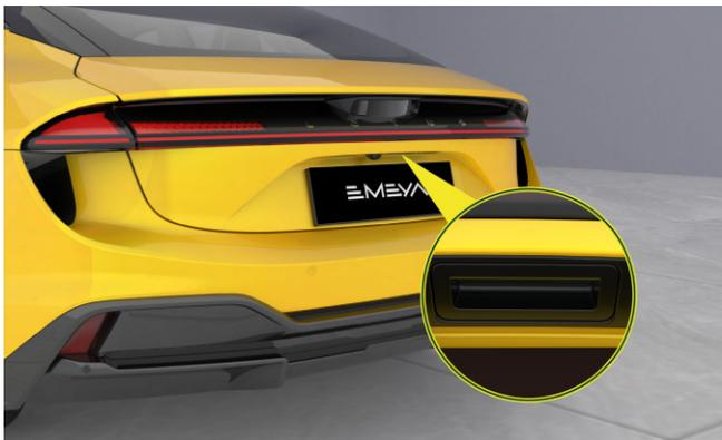
Sblocco di emergenza tramite interruttore di apertura del portellone posteriore
