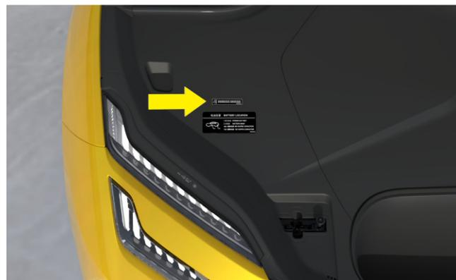
Posizione dell'etichetta del motore di azionamento anteriore
