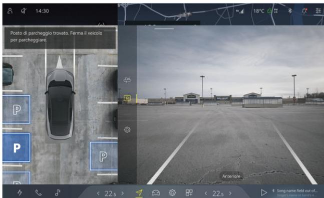
3. Quando viene rilevato uno spazio di parcheggio disponibile, premere il pedale del freno per fermare stabilmente il veicolo. Il conducente può scendere dall'auto con la chiave e il telefono validi dopo aver cliccato sul **PARCHEGGIO REMOTO** pulsante e inserito la marcia P.
