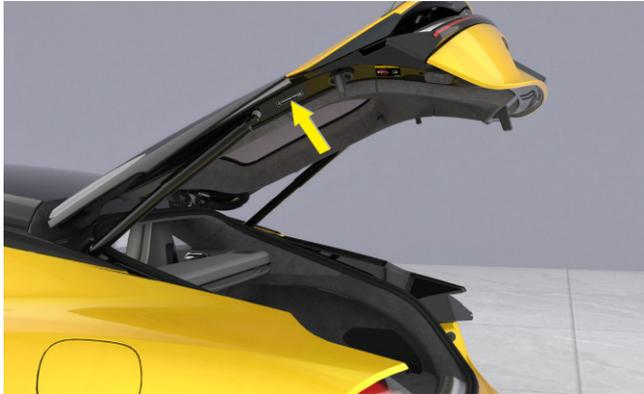
Posizione dell'etichetta del motore di azionamento posteriore
