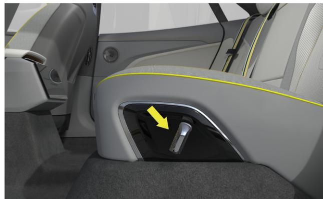
Regolazione del sedile posteriore per il modello a 5 posti
