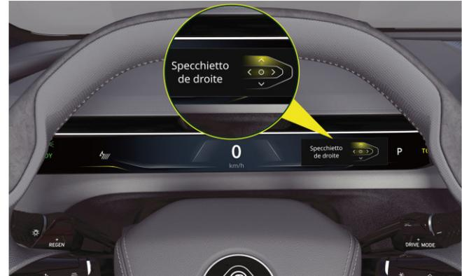
**Interfaccia di regolazione dello specchietto con funzione di streaming tramite il pulsante sul volante\***
