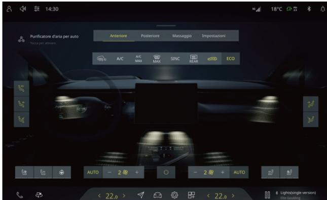
Sull'interfaccia di controllo dell'aria condizionata, toccare due volte per attivare il flusso d'aria corrispondente e toccare di nuovo due volte per spegnerlo. Toccare e trascinare il flusso d'aria per regolarne la direzione.
