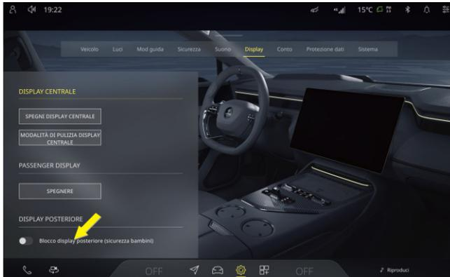
Dopo aver attivato la funzione di **Blocco del display posteriore (Blocco per i bambini)**, toccando il display posteriore si accende brevemente lo schermo, dove appare il metodo per riaprire il display posteriore. Se non si opera per un certo periodo di tempo, il display posteriore si blocca automaticamente.
