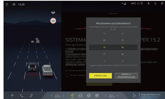
È inoltre possibile programmare un aggiornamento del sistema OTA in qualsiasi momento entro 24 ore. Una volta impostato, l'icona dell'aggiornamento programmato verrà visualizzata in alto a destra dell'interfaccia. Il sistema avvierà automaticamente l'aggiornamento OTA all'ora prevista quando la rete è connessa.
