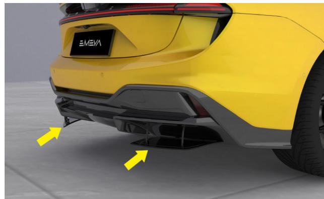
Il diffusore posteriore attivo si trova sotto il paraurti posteriore. Quando la velocità del veicolo è superiore a 90 km/h, il diffusore posteriore attivo si attiva automaticamente. Quando la velocità del veicolo è inferiore a 30 km/h, il diffusore posteriore attivo, se acceso, si spegne automaticamente.
