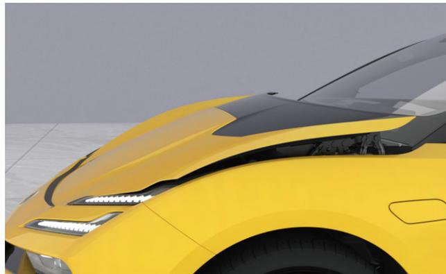
Quando il sensore di impatto con i pedoni rileva che si verificherà una collisione frontale con il veicolo in marcia a 28~50 km/h, il controllo della protezione dei pedoni si attiverà immediatamente e la parte posteriore del cofano si solleverà.
