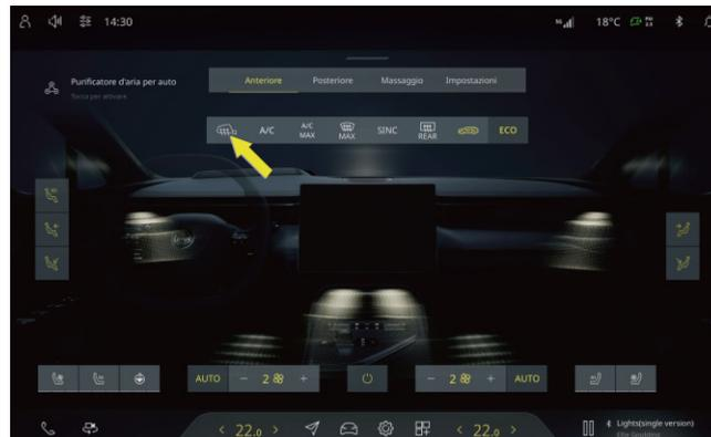
Fare clic su **TEMP** nel CSD per passare all'interfaccia del climatizzatore dove è possibile attivare o disattivare la funzione di sbrinamento/disappannamento dello specchietto retrovisore per rimuovere pioggia, acqua nebulizzata o ghiaccio e neve.
