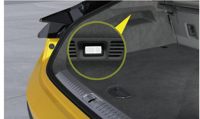
Quando si apre il portellone posteriore, la luce del bagagliaio si accende automaticamente. Quando il portellone posteriore è chiuso, la luce del bagagliaio si spegne automaticamente.
