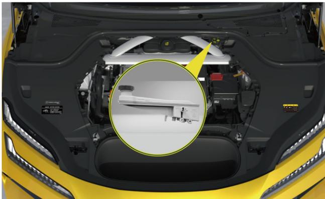
Controllare periodicamente il livello del liquido dei freni per assicurarsi che sia compreso tra i segni MIN e MAX.
