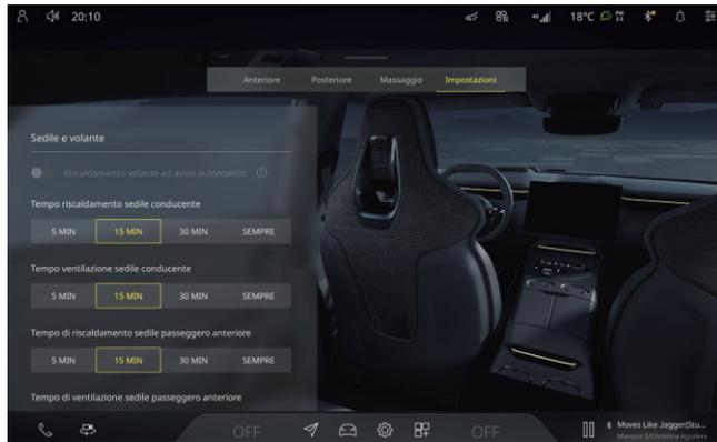
Toccare **Impostazioni** nell'interfaccia di controllo A/C sul CSD per passare all'interfaccia di impostazione della ventilazione del sedile anteriore.
