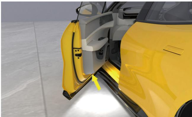
Quando l'ambiente esterno è buio, le luci del pavimento si accendono automaticamente all'apertura delle porte e si spengono automaticamente alla loro chiusura.
