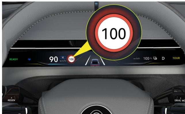
L'allarme si attiva quando la velocità del veicolo supera il limite di velocità riconosciuto dal sistema; l'allarme viene disattivato quando la velocità del veicolo è inferiore al limite di velocità riconosciuto dal sistema fino a quando non viene rilevato un nuovo limite di velocità.
