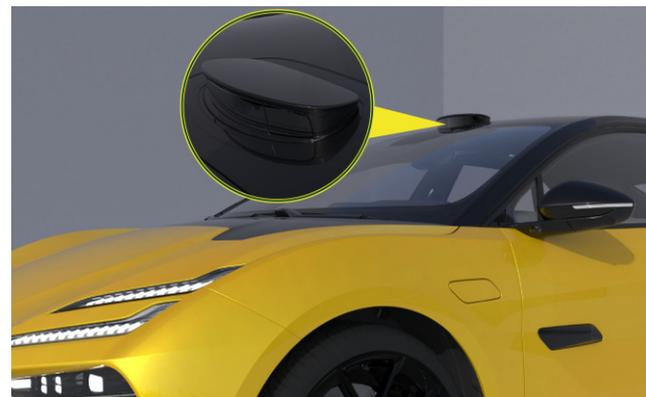
aprire **la funzione Benvenuti** ( p.117 ) e quando il veicolo viene sbloccato, il LiDAR si apre e si ripiega automaticamente.
