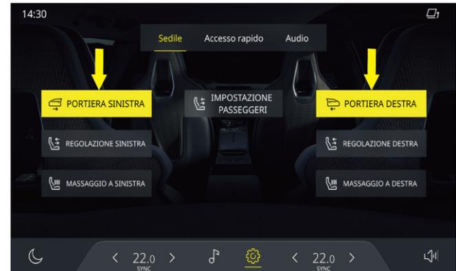
Interruttore di chiusura della portiera posteriore sul display posteriore
