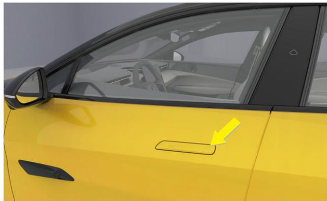
Quando la funzione di sblocco all'avvicinamento è disattivata, tenendo con sé la chiave telecomando e toccando l'interruttore della maniglia della portiera del conducente, il veicolo può essere bloccato o sbloccato.
