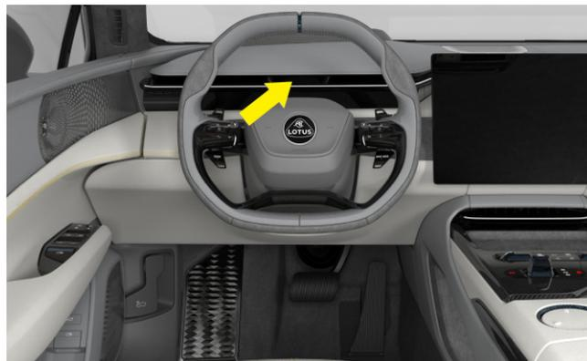
Telecamera di rilevamento dello stato del conducente
