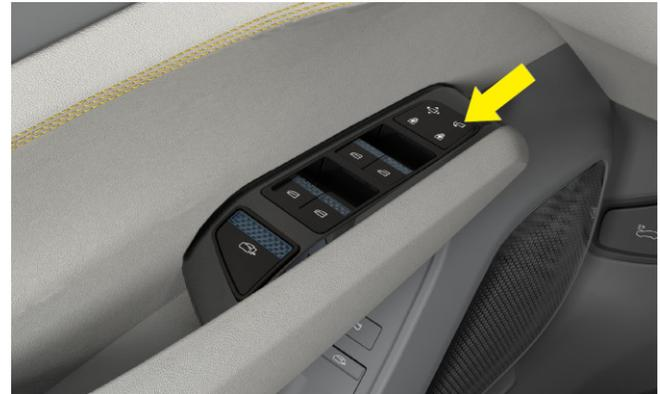
Interruttore di ripiegamento dello specchietto laterale esterno
