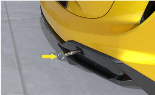
Foro di montaggio dell'anello di traino del paraurti posteriore
