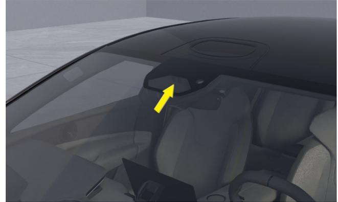
Lo schermo con microonde è fissato orizzontalmente al centro, in posizione verticale verso l'alto del parabrezza anteriore. Le informazioni sul veicolo sono memorizzate nello schermo con microonde. Tenere pulito il parabrezza anteriore per evitare che oggetti estranei blocchino lo schermo con microonde.
