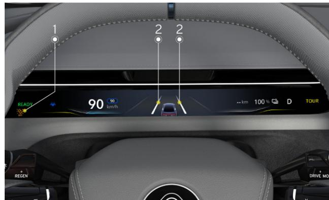
1. Spia di stato dell'assistenza al mantenimento della corsia
