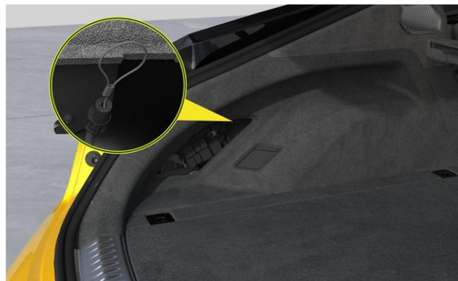
La fune di emergenza della serratura elettronica è installata dietro il coperchio di riparazione interna posteriore sinistra nel vano bagagli.
