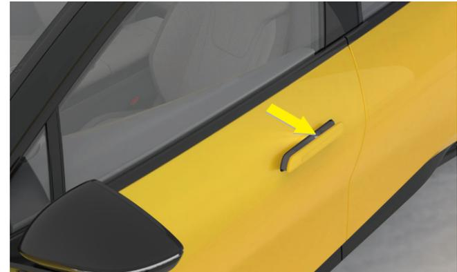
Quando la luce ambientale all'esterno del veicolo è insufficiente, la luce del manubrio si accende per illuminare l'interno della maniglia della porta per facilitare lo sblocco del veicolo e si spegne automaticamente dopo un certo periodo di tempo.
