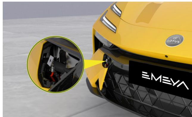
Sblocco di emergenza tramite alimentazione esterna
