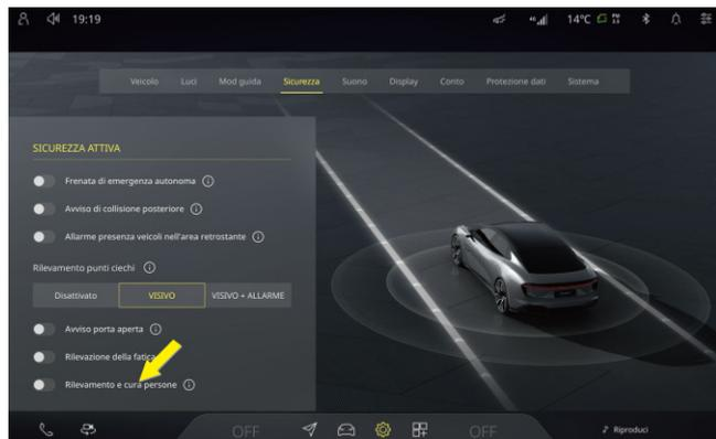
Il sistema di rilevamento e cura della vita sono attivati per impostazione predefinita e si può scegliere di attivare o disattivare questa funzione toccando l'
