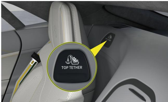
Dispositivo di fissaggio dell'imbracatura superiore
