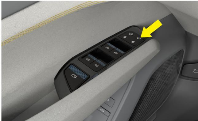
Interruttore di ripiegamento dello specchietto retrovisore con funzione di streaming
