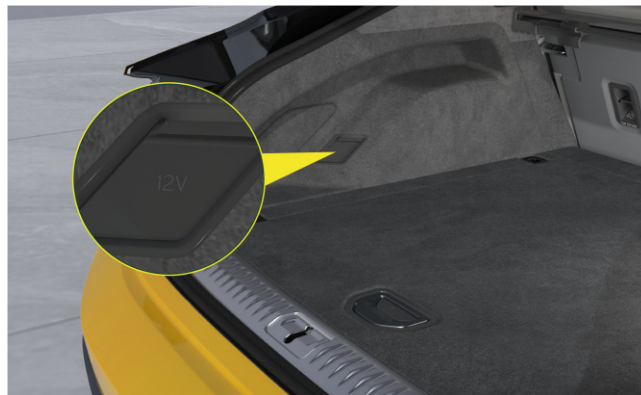
12 Volt strömförsörjning i bagageutrymmet
