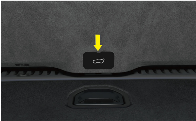
Nödöppning av bakluckans lock
