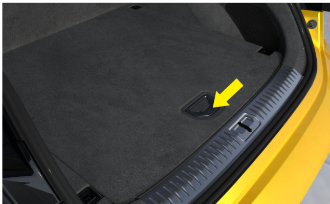
Vak onder vloer bagageruimte
