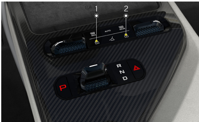
Zentralverriegelung an der Tunnelkonsole
