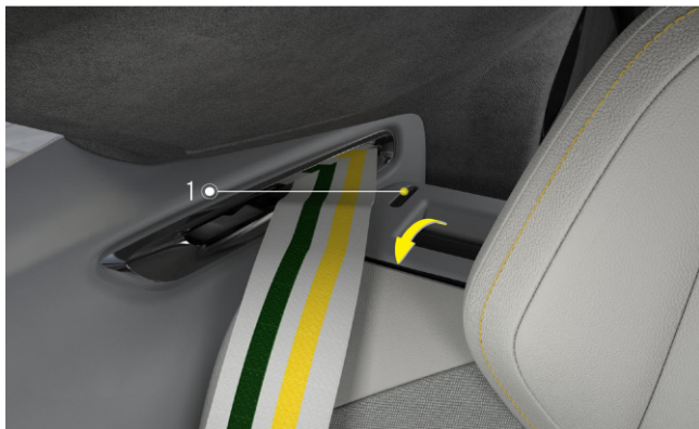
Verriegelung neben der Kopfstütze
