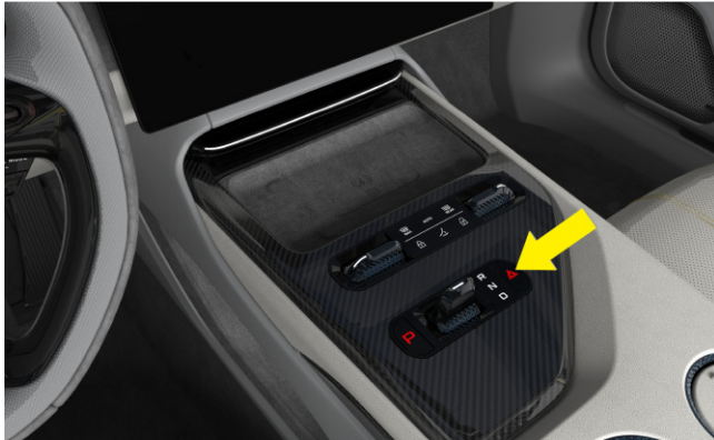
Schalter für die Warnblinkanlage
