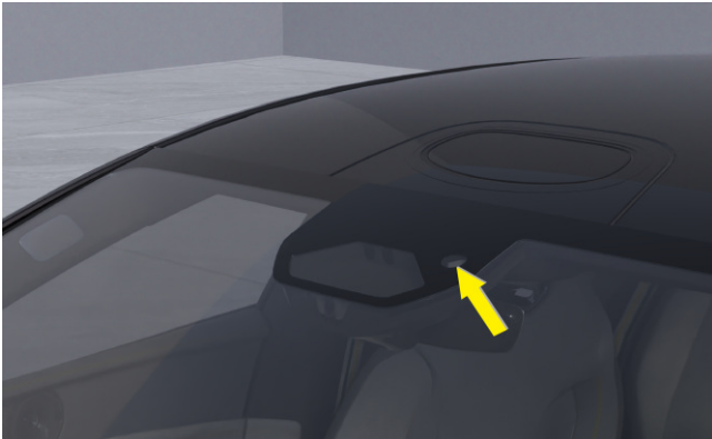
Regen- und Lichtsensormodul (RLSM)
