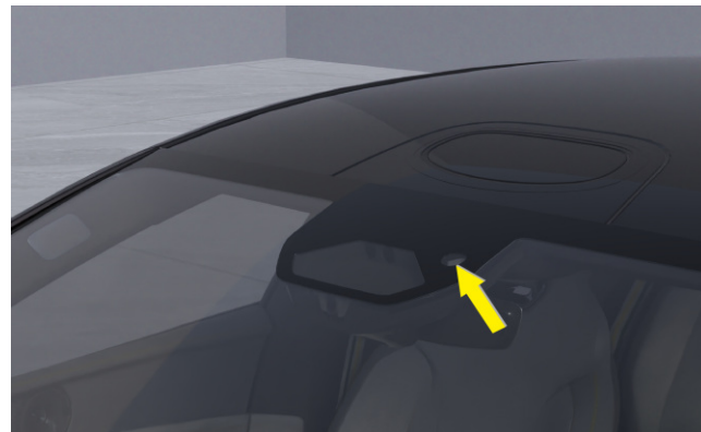
Regen- und Lichtsensormodul (RLSM)
