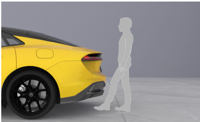
Heckklappen-Erfassungsbereich für Trittbewegung
