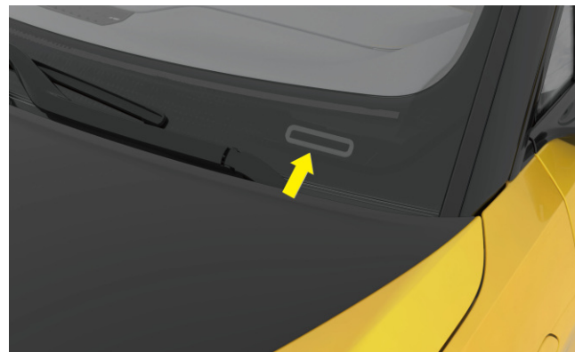
VIN in der linken unteren Ecke der Windschutzscheibe
