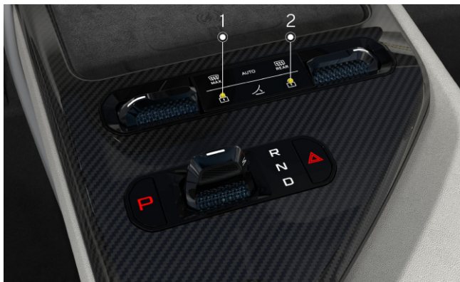
Zentralverriegelung an der Tunnelkonsole
