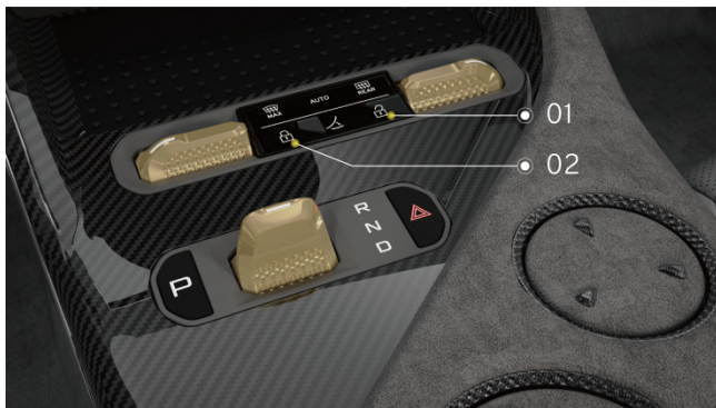
Sentrallås på tunnelkonsollen
