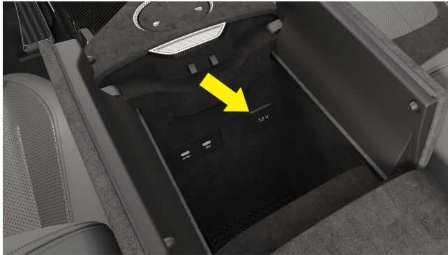
Alimentazione a 12 V nella scatola del bracciolo anteriore
