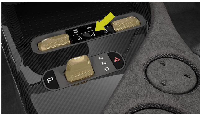
Interruttore del vano portaoggetti
