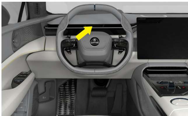
Førerovervågningskamera for træthed
