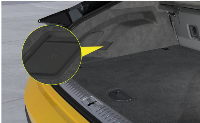
12V strømforsyning i bagagerummet
