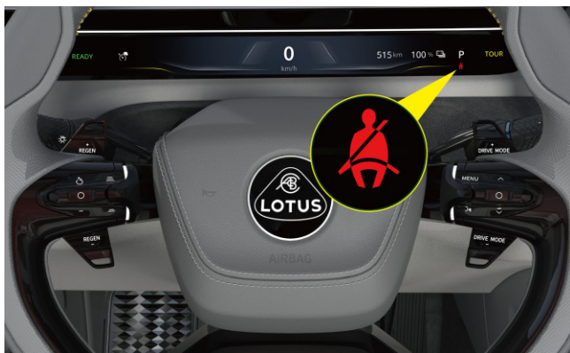
Sikkerhedsselen er ikke fastgjort
