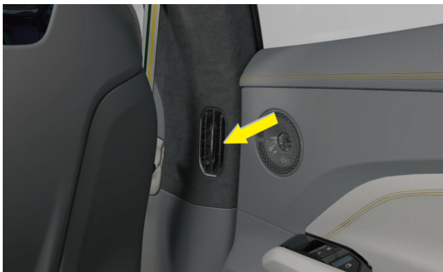
Luftudtag på bagsiden
