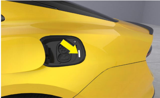
Indikator for opladningsport
