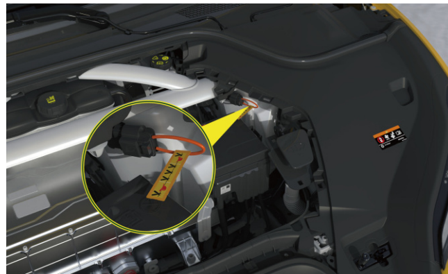
MSD med lav spænding
