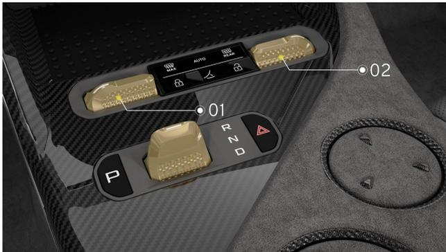
1. Schalter für die Temperatureinstellung auf der Fahrerseite
