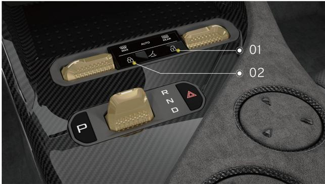
Zentralverriegelung an der Vorderseite der Tunnelkonsole
