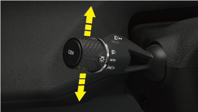
Bewegen Sie den Lenkradschalter leicht nach oben/unten, damit die Fahrtrichtungsanzeiger
