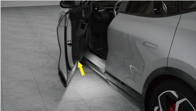
Wenn die äußere Umgebung dunkel ist, werden die Bodenbeleuchtungen automatisch beleuchtet, wenn die Türen geöffnet sind, und sie gehen automatisch aus, wenn die Türen geschlossen sind.
