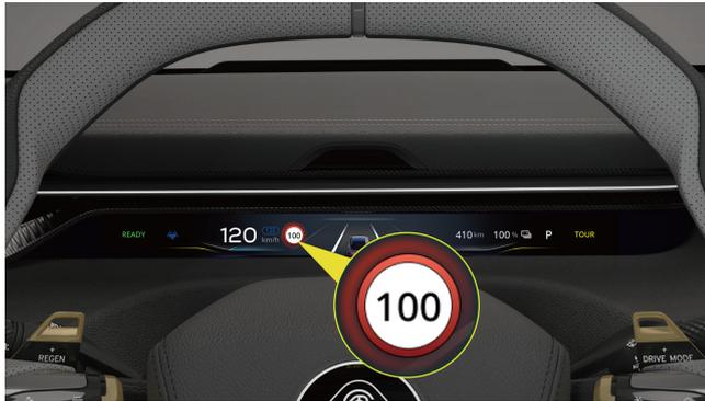
Der Alarm wird ausgelöst, wenn die Fahrzeuggeschwindigkeit die vom System erkannte Geschwindigkeitsbegrenzung überschreitet; Der Alarm wird ausgelöst, wenn die Fahrzeuggeschwindigkeit unterhalb der vom System erkannten Geschwindigkeitsbegrenzung liegt, bis eine neue Geschwindigkeitsbegrenzung erkannt wird.
