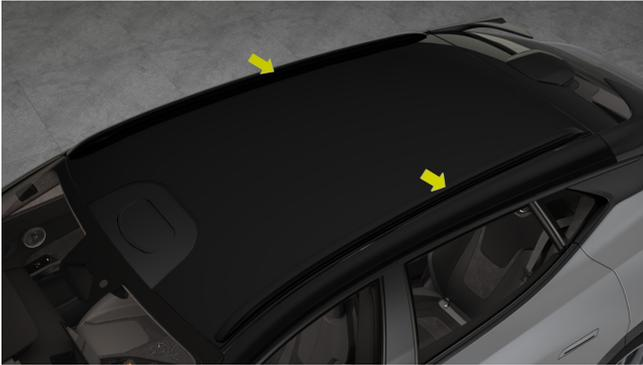
Die Gepäckträger befinden sich auf beiden Seiten des Fahrzeugdachs.
