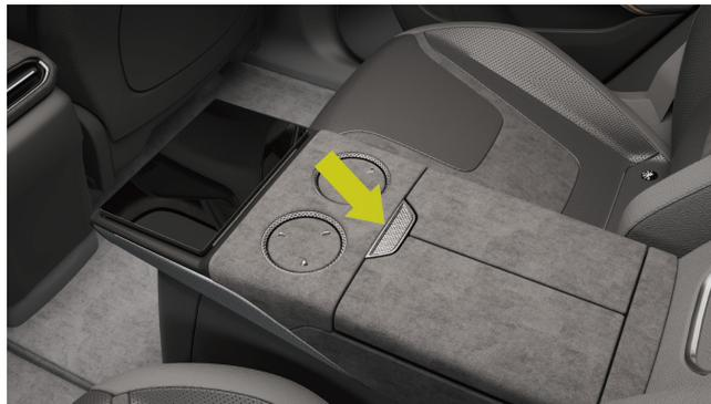
Öffnen/Schließen des Kastens der hinteren Mittelarmlehne
