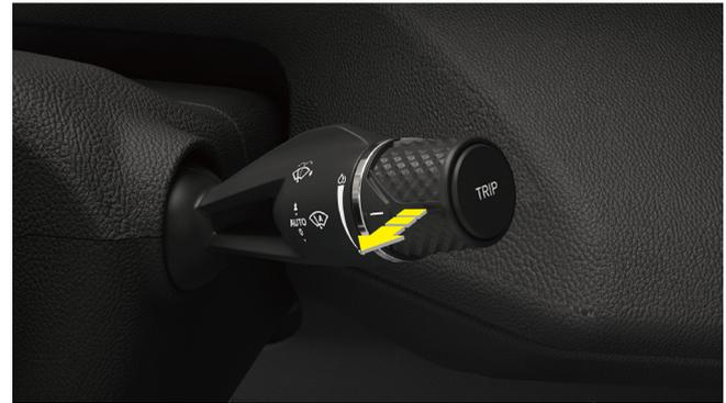
Drehen Sie den Wischerhebel zurück, der Wäscher sprüht Wasser und der Wischer kratzt ein paar Mal, bevor er zum niedrigsten Punkt zurückkehrt.
