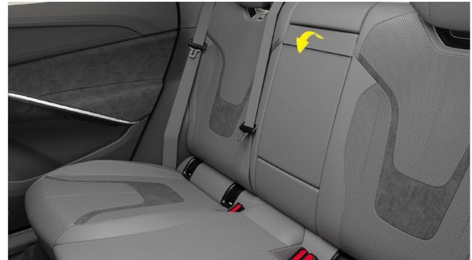
Die Mittelarmlehne befindet sich in der Mitte der Rücksitzlehne, die heruntergedreht und zum Gebrauch herausgezogen und zum Schließen nach oben gedreht und zurück in die Rückenlehne gepresst werden kann.
