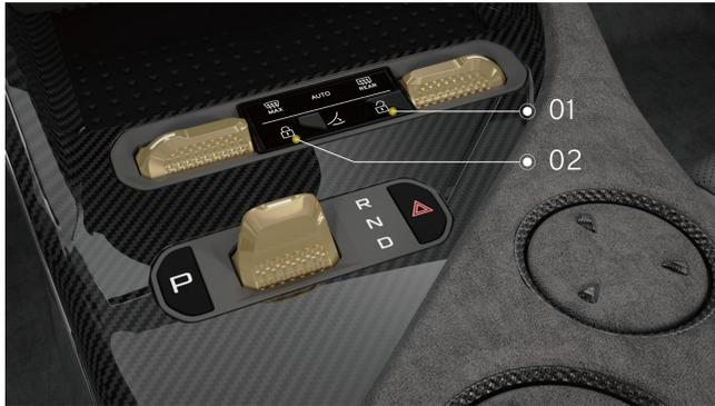
Zentralverriegelung an der Vorderseite der Tunnelkonsole
