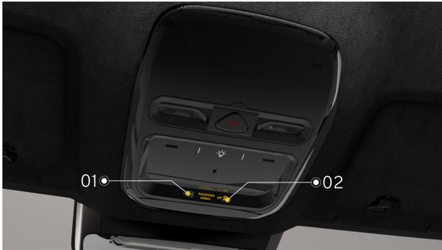
1. Die Airbaganzeige des Beifahrers ist eingeschaltet
