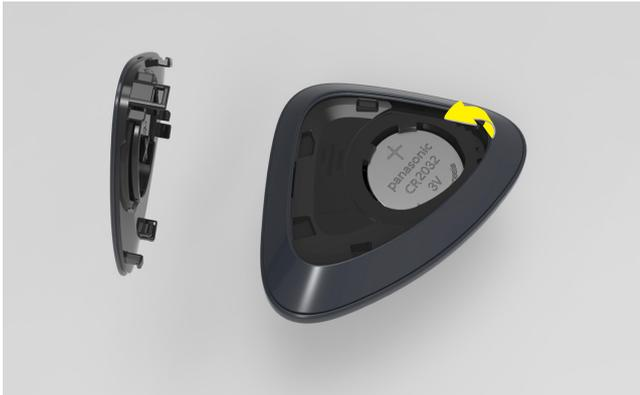
3. Verwenden Sie die Kausche, und stecken Sie sie in den Spalt zum Anheben der Batterie. Der empfohlene neue Batterietyp ist: CR2032.
