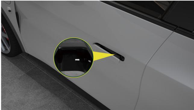
Wenn das Ambientelicht außen am Fahrzeug nicht ausreicht und das Fahrzeug entriegelt wird, wird die Türgriffleuchte auf der Innenseite des Türgriffs eingeschaltet. Diese Leuchte erlischt nach einer gewissen Zeit automatisch.
