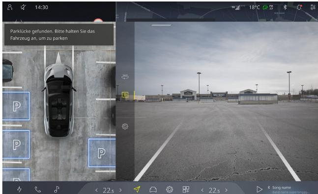
3. Wenn eine freie Parklücke gefunden wird, betätigen Sie das Bremspedal, um das Fahrzeug stabil zu halten, und klicken Sie auf die **Taste IN CAR**.
