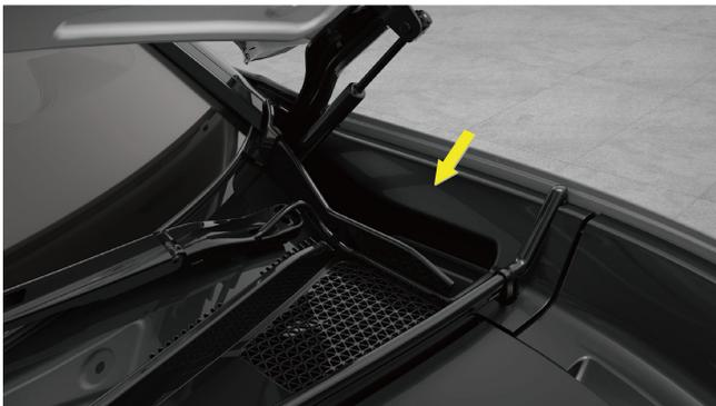
3. Drücken Sie den Verriegelungshebel der Ladeanschlussabdeckung nach hinten, um die Ladeanschlussabdeckung zu entriegeln, ziehen Sie sie dann aus dem Spalt heraus und öffnen Sie die Ladeanschlussabdeckung.
