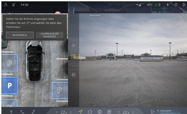
4. Folgen Sie den Anweisungen, um das Bremspedal und das Lenkrad zu lösen, und fahren Sie automatisch in die Parklücke.
