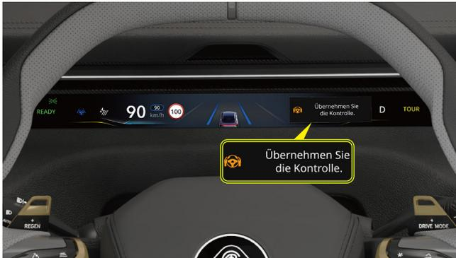
Wenn das HWA in Betrieb ist und das System erkennt, dass der Fahrer das Lenkrad nicht festhält, wird es auf dem kombinierten Instrument angezeigt, um die Textaufforderungen des Fahrzeugs zu übernehmen, begleitet von übergeordnetem Promptton. Wenn der Alarm ignoriert wird, tritt die HWA aus.
