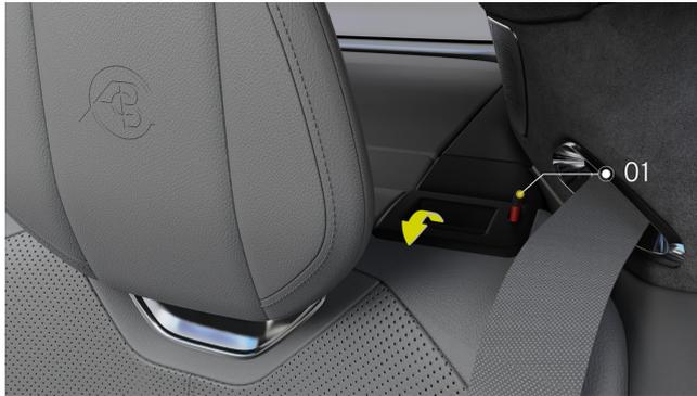
Die Verriegelung befindet sich an der Außenseite der Kopfstütze
