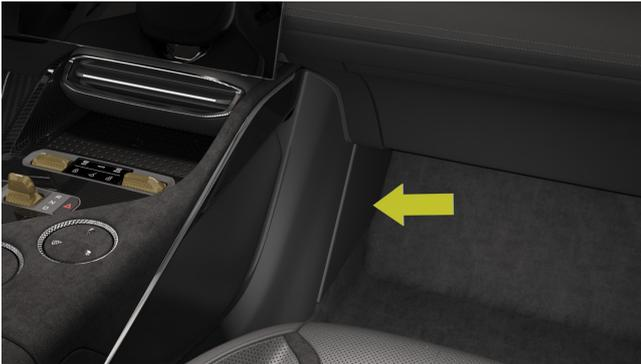
Der zentrale Sicherungskasten befindet sich auf der rechten Seite der Tunnelkonsole, die durch Entfernen der vorderen rechten Blende der Tunnelkonsole zu sehen ist.
