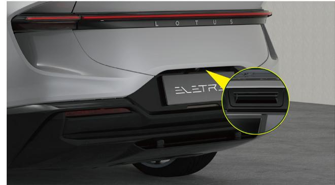
Notfallentsperrung über Heckklappenöffnungsschalter
