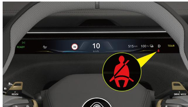
Wenn Fahrer und Fahrgäste im Auto keinen Sicherheitsgurt tragen, zeigt die Kombinationsinstrumententafel eine Erinnerung an die Nichtbefestigung des Sicherheitsgurts an und gibt Alarm aus, und das zentrale Display zeigt auch den entsprechenden Textinhalt an. Wenn der Sicherheitsgurt befestigt ist und die Erinnerung und Alarm für ungeschnallte Sicherheitsgurte fortgesetzt werden, nehmen Sie bitte das Gewicht vom leeren Sitz ab. Wenn
