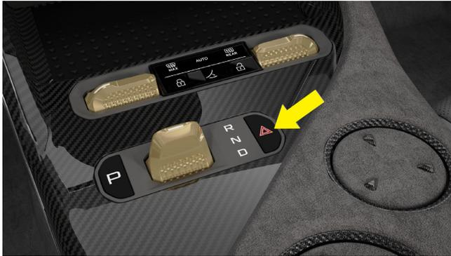
Im Falle eines Notfalls während der Fahrt drücken Sie bitte den Warnblinkschalter, um die Warnblinkanlage zu aktivieren.
