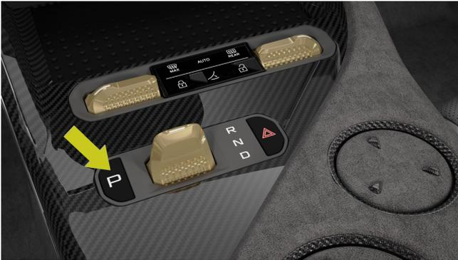
Nach dem Parken des Fahrzeugs drücken Sie die P-Taste, der Gang schaltet in den P-Gang und die elektronische Feststellbremse wird automatisch aktiviert.
