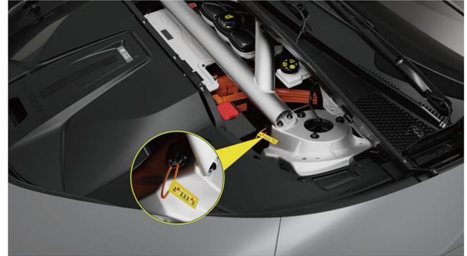
4. Finden Sie die Niederspannungs-MSD in der Motorhaube und entfernen Sie sie, und das Fahrzeug deaktiviert das Hochspannungssystem automatisch.
