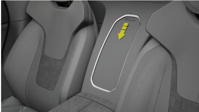
Die Tasche an der Rücksitzlehne befindet sich in der Mitte der Rücksitzlehne und wird bis zur unteren Verriegelung heruntergedrückt; durch erneutes Drücken schließt es sich automatisch.
