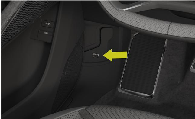
2. Ziehen Sie nacheinander zweimal den Motorhaubenöffnungsgriff, um die Motorhaube zu entsperren und schließen Sie alle Türen und den Kofferraumdeckel.
