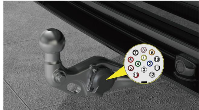
Nach dem Öffnen der Schutzabdeckung kann er verwendet werden. Der mit diesem Fahrzeug ausgestattete elektrische Stecker verwendet eine 13-Kern-Spule, und der für die Steckdose verwendete Standard ist ISO 11446:2004. Die spezifischen Pin-Funktionen sind wie folgt:
