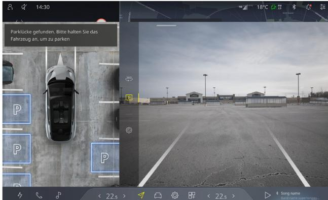
3. Wenn eine freie Parklücke erkannt wird, betätigen Sie das Bremspedal, um das Fahrzeug stabil zu halten. Der Fahrer kann mit gültigem Schlüssel und Telefon aus dem Auto aussteigen, nachdem er auf die Taste **REMOTE PARKEN** geklickt und den P-Gang eingelegt hat.
