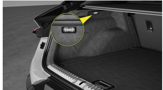
Beim Öffnen des Kofferraumdeckels schaltet sich die Beleuchtung im Kofferraum automatisch ein; beim Schließen des Kofferraumdeckels erlischt die Beleuchtung im Kofferraum automatisch.
