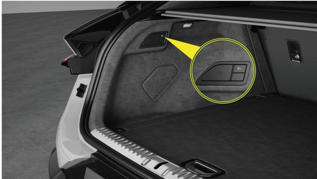
1. Öffnen Sie die Heckklappe, drücken Sie den elektrischen Schlepphakenschalter im Kofferraum. Der elektrische Schlepphaken erstreckt sich automatisch.
