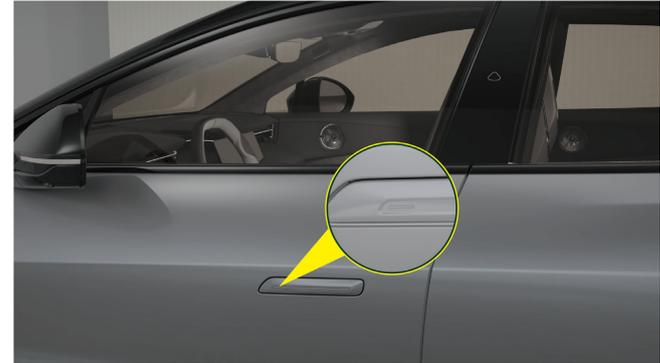
Tragen Sie einen gültigen Schlüsselanhänger und berühren Sie den Fahrertürgriff-Schalter, um das Fahrzeug zu verriegeln/entriegeln; nähern Sie sich dem Fahrzeug innerhalb eines bestimmten Bereichs und das Fahrzeug entriegelt sich automatisch.
