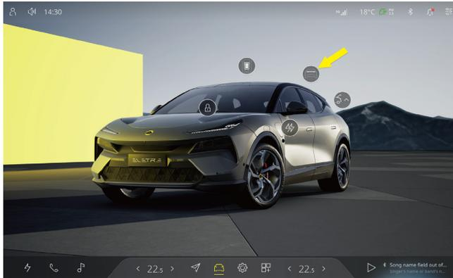
Schnittstelle zur aktiven Steuerung des Heckflügels
