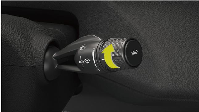
Die Empfindlichkeit der Regenerkennung kann durch das Empfindlichkeitsrollenrad des Sonnenlicht- und Regensensors angepasst werden; Durch Drehen des Rollenrads nach oben ist die Empfindlichkeit höher und die Wischintervalle kürzer.
