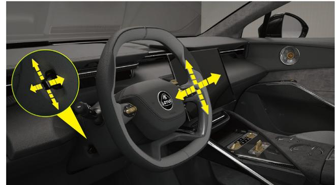
Wenn das Fahrzeug eingeschaltet ist, können Sie das Lenkrad nach oben, unten, vorwärts und rückwärts verstellen, indem Sie den Verstellknopf auf der linken Seite der Lenksäule ziehen.
