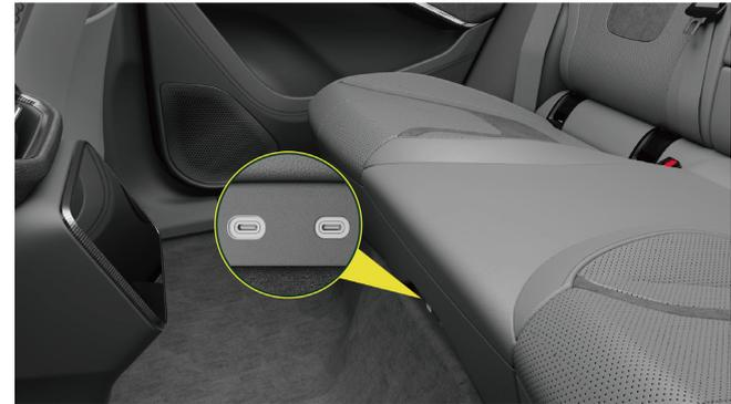
In der unteren Mitte des Rücksitzkissens befinden sich zwei TYP-C-Anschlüsse, die von den Passagieren zum Aufladen genutzt werden können.
