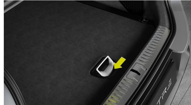
Unter dem Kofferraumboden befindet sich ein zusätzliches Fach, das zur Aufbewahrung der Ladegeräte im Fahrzeug genutzt werden kann.
