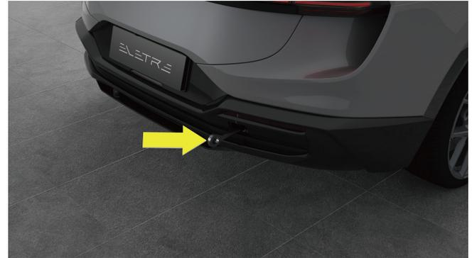
4. Schrauben Sie die Abschleppöse an Ort und Stelle und straffen Sie weiter, bis die Abschleppöse vollständig eingeschraubt ist und die Abschleppvorrichtung an der Abschleppöse befestigt ist.
