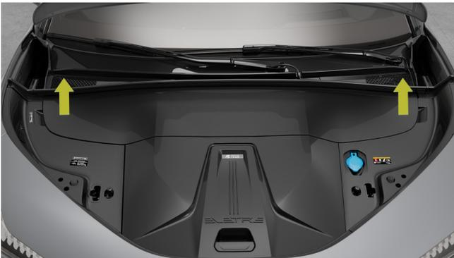
Es kann Blätter und Insekten in den A/C-Außenöffnungen im Gitter unter der Rückseite der Motorhaube angesammelt sein, also reinigen Sie sie regelmäßig, um Blockaden zu vermeiden.
