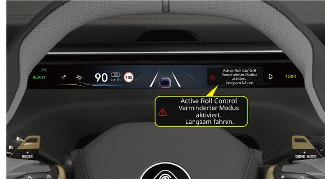
Wenn auf dem Kombiinstrument ein Fehleralarm im Zusammenhang mit dem Lotus intelligenten Anti-Roll-Steuersystem angezeigt wird, dürfen Sie nicht auf rauen Straßen fahren und mit niedriger Geschwindigkeit drehen. In diesem Fall wenden Sie sich rechtzeitig an das Lotus Customer Care Centre, um den Fehler zu beheben.
