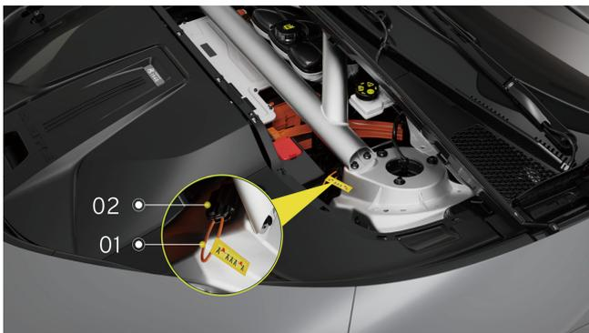
1. Niederspannungs-MSD- (manuelle Servicetrennung) Kabel
