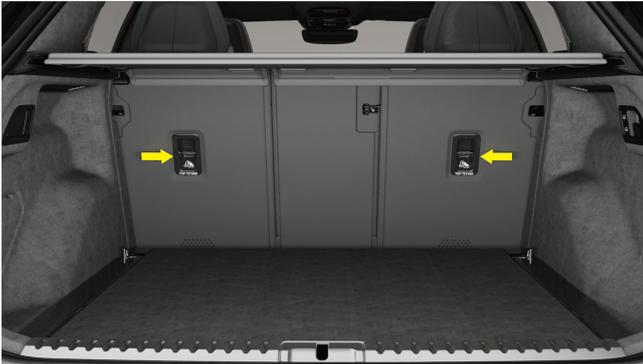
Die obere Gurthalterung befindet sich hinter der Rücksitzlehne.
