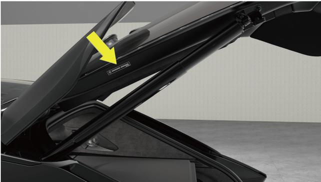
Position des hinteren Antriebsmotorslabels
