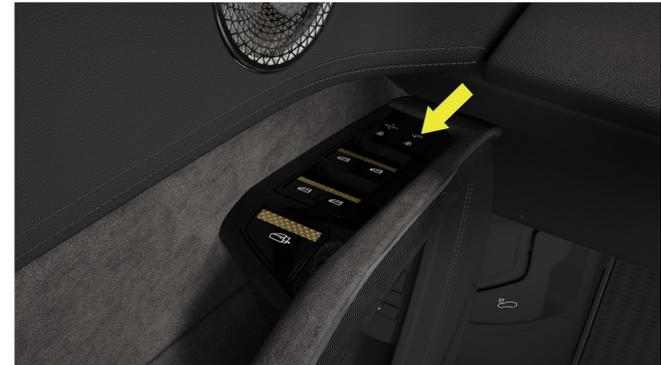
Schalter zum Umklappen des Streaming-Spiegels
