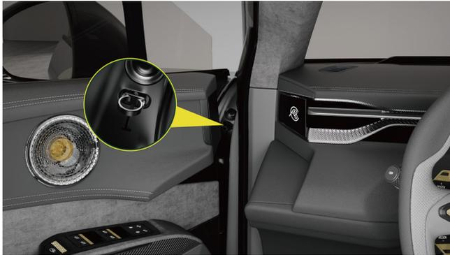
Das Notseil des elektronischen Schlosses befindet sich am oberen Scharnier der Fahrertür.
