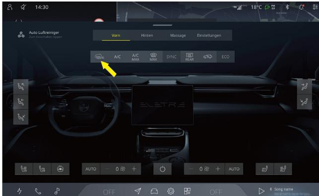
Schalter zum Entfrosten/Entnebeln des Streaming-Spiegels
