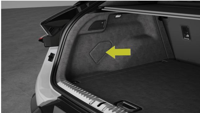
Entfernen Sie den Kofferraum, um den hinteren elektrischen Sicherungskasten zu finden.
