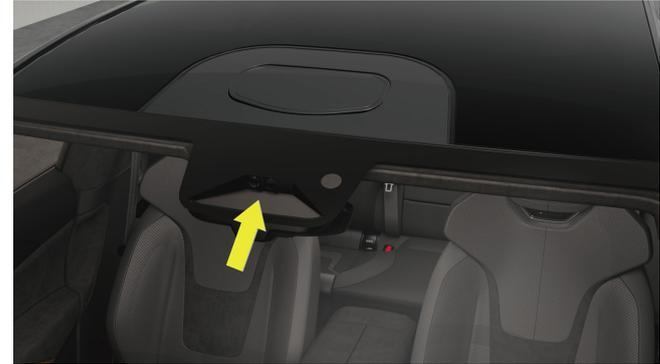
Das Mikrowellenfenster ist über der Mitte der Windschutzscheibe angebracht. Im Mikrowellenfenster sind Fahrzeugdaten gespeichert. Halten Sie die Windschutzscheibe sauber und achten Sie darauf, dass das Mikrowellenfenster nicht durch Fremdkörper blockiert wird.
