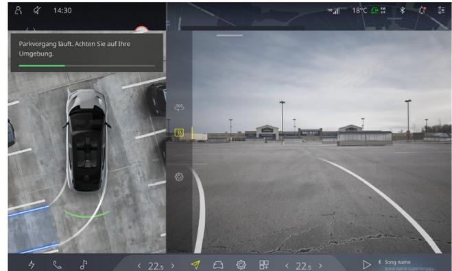
5. Wenn der automatische Parkvorgang abgeschlossen ist, zeigt CSD an, dass der Parkvorgang beendet ist.
