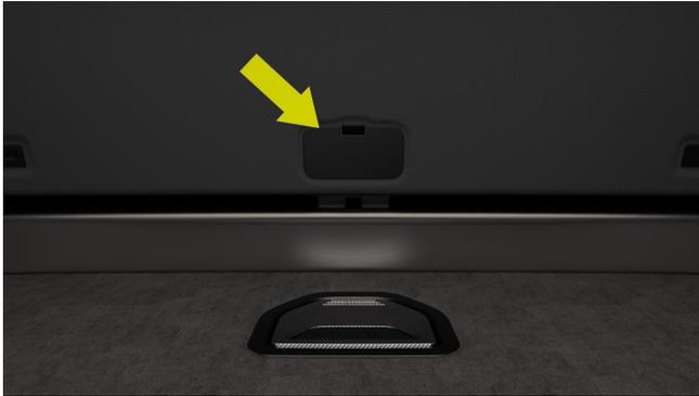
Heckklappe Notfallentsperrung Schutzabdeckung
