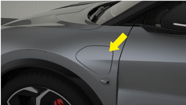
Öffnen Sie die Abdeckung des Ladeanschlusses
