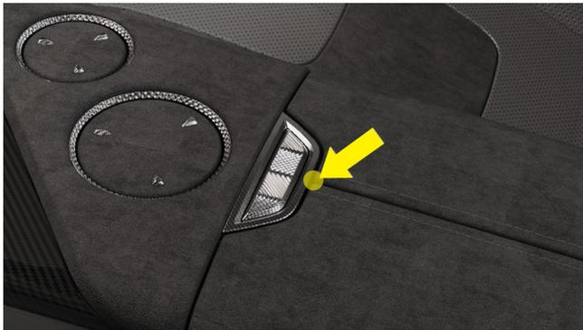
Nach dem Schließen der Armlehne kann das Ladekabel oder das Datenkabel von der angezeigten Position aus verlängert werden.
