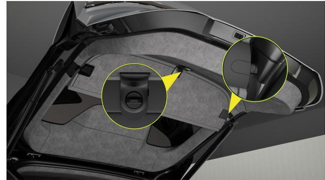
Die Heckgarderobe ist an der Innenverkleidung der Heckklappe angebracht. Sie können ihn an beiden Enden auf die Spindel klemmen, den Knopf auf den Befestigungspunkt der Heckklappe ausrichten und im Uhrzeigersinn drehen, um die Kleiderablage zu verriegeln.
