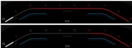
La velocidad máxima del motor se gradúa hasta un máximo de 6000 rpm durante el calentamiento del motor hasta que se haya alcanzado la
