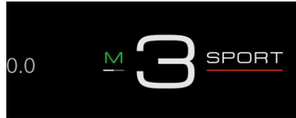
Si no se acciona una palanca en un intervalo de 20 segundos, la transmisión volverá al modo automático y seleccionará la marcha adecuada, que podría diferir de la última marcha seleccionada manualmente.
