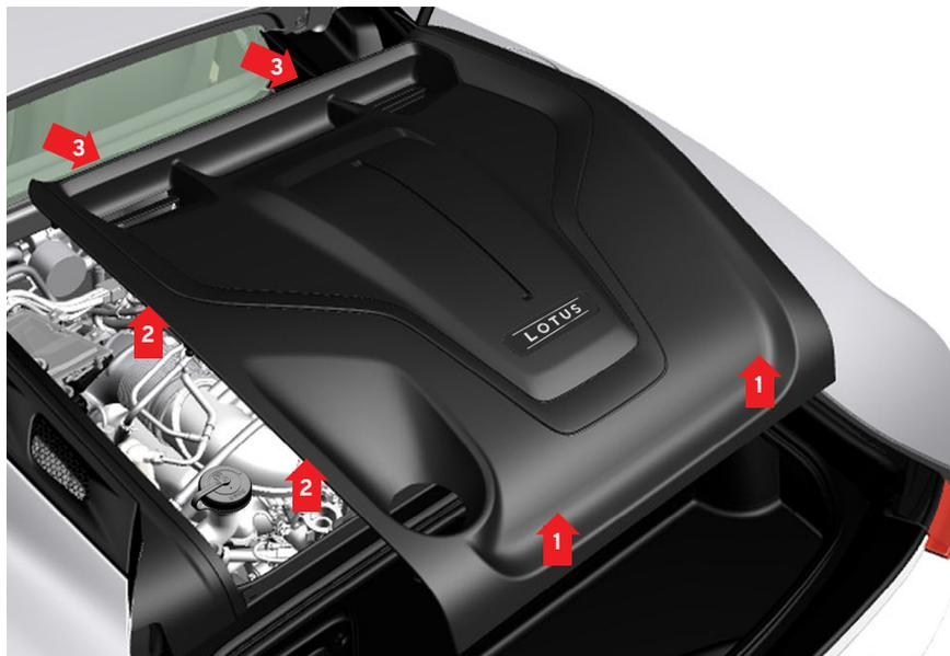
Antes de cerrar el portón trasero, compruebe que todos los paneles del compartimento del motor se hayan colocado correctamente y estén bien sujetos.
