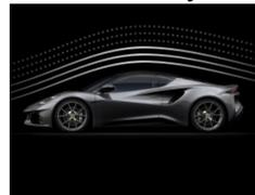
Pulse o para mostrar la fuerza que ejerce la carga aerodinámica actual. El número de líneas de aire iluminadas por encima del vehículo aumenta a medida que aumenta la carga aerodinámica.
