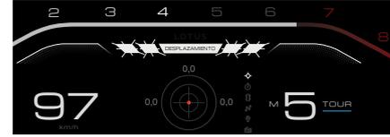
Si se ignora la indicación de cambiar de marcha y el régimen del motor supera el punto de cambio final, las líneas de cambio de alto rendimiento y los bloques parpadearán más rápido.
