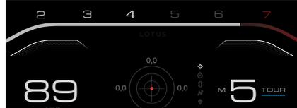
El aumento continuado de las revoluciones del motor mientras se permanece en la misma marcha iluminará los bloques de cambio del tercer nivel interior.
