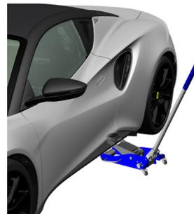
7. Coloque un gato adecuado en el punto de elevación trasero identificado con un adhesivo azul; véase la sección “Elevación del vehículo” en la página 226. Esto elevará las dos ruedas de ese lado del vehículo.
