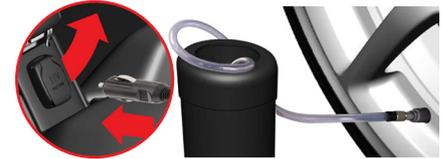
11. Coloque el compresor cerca del neumáticos, asegurándose de que la botella de sellador esté en posición vertical.
