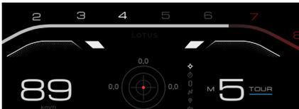
Si el régimen del motor sigue aumentando mientras se mantiene la misma marcha, se alcanzará el segundo nivel de cambio, iluminándose los bloques de cambio exteriores.
