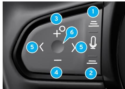
El control de cruceo y el control de cruceo adaptativo se accionan mediante los interruptores situados en el lado izquierdo del teclado del volante.
