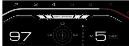
Las líneas de cambio de alto rendimiento y los bloques de cambio parpadearán lentamente y se mostrará **DESPLAZAMIENTO** a medida que el régimen del motor siga aumentando, indicando al conductor que se ha alcanzado el punto de cambio ideal.
