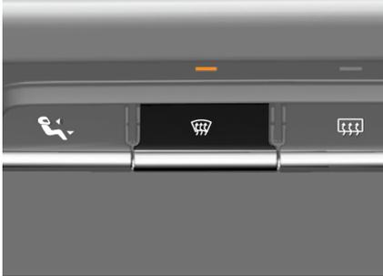
No se puede seleccionar la recirculación manual con el sistema antivaho activado.
