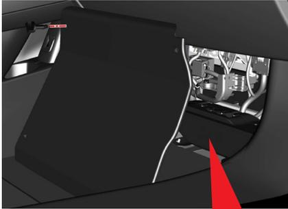
El panel del rodapié es un componente de protección de los ocupantes en caso de colisión. No conduzca nunca el vehículo sin que el rodapié esté instalado y colocado correctamente.
