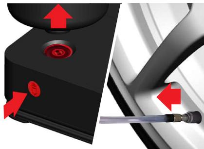
17. Desconecte el conector del compresor de la toma de corriente auxiliar de 12 V, pulse el botón situado en el lateral del compresor para separar el frasco de sellador de neumáticos y vuelva a colocar el tapón de la válvula del neumático.
