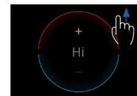
Pulse y arrastre hacia arriba justo fuera de la pantalla para ajustar la temperatura "Hi".
