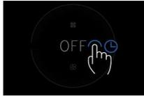
Pulse unos segundos dentro de la pantalla para ajustar la velocidad a '7' u 'OFF'.
