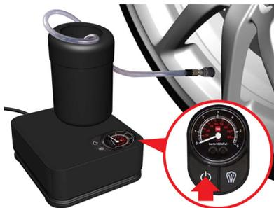
15. Pulse el botón de encendido y apagado
