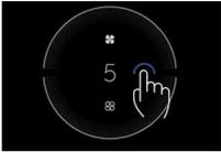
Toque el interior de la pantalla para aumentar o disminuir la velocidad en un nivel.
