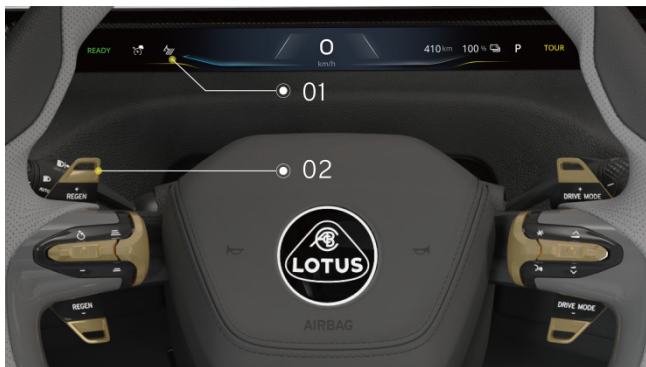
Niveau van energierugwinning
