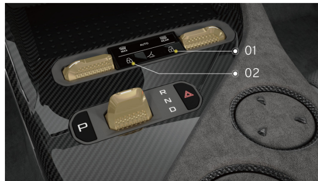
Centrale vergrendeling op de tunnelconsole
