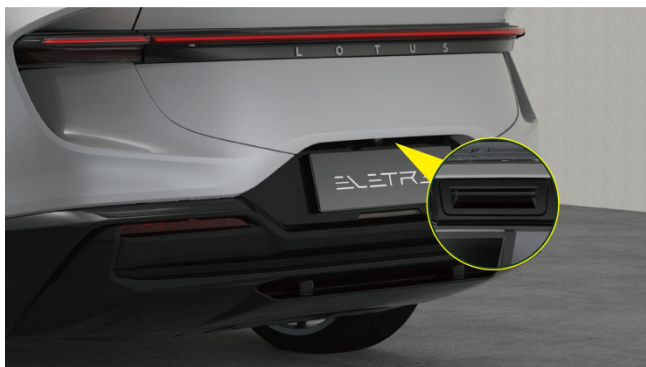
Noodontgrendeling via schakelaar voor openen van achterklep
