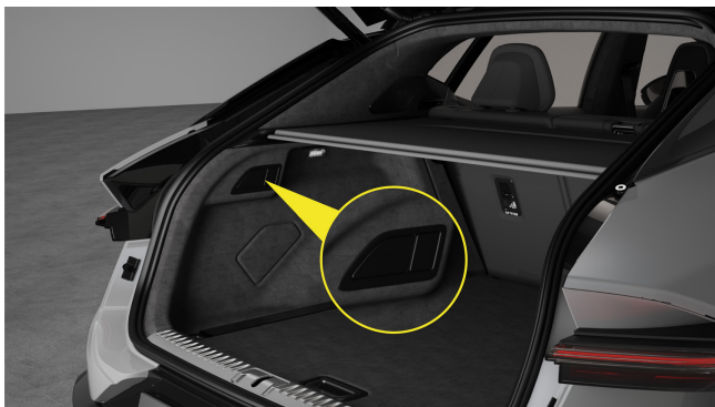
Alimentation électrique 12 V dans le coffre
