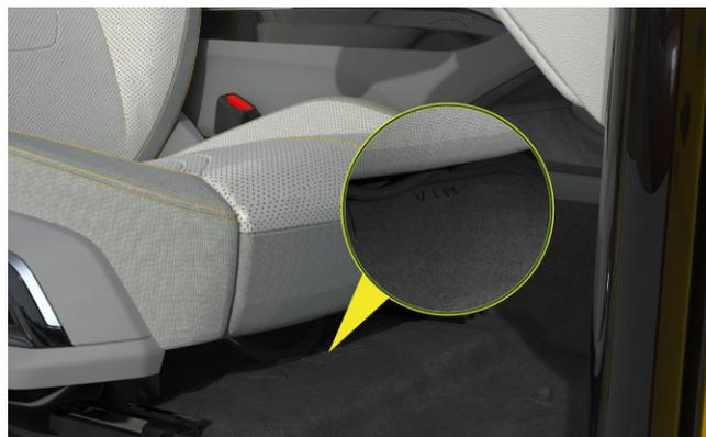
VIN au niveau de la traverse du siège avant droit
