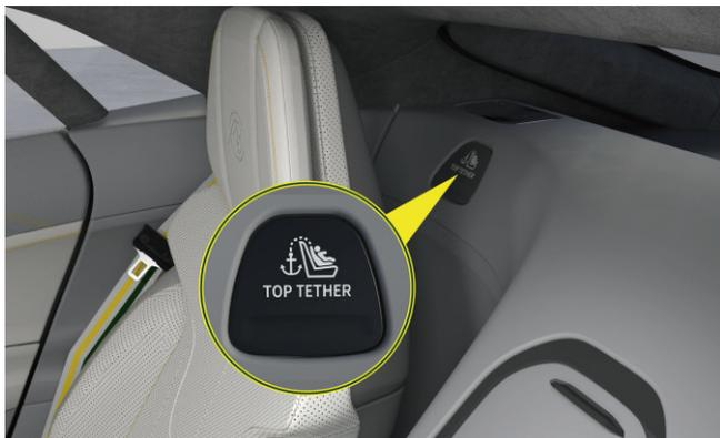
L'ancrage de l'attache supérieure du siège de sécurité pour enfants est situé derrière l'appui-tête du siège arrière.
