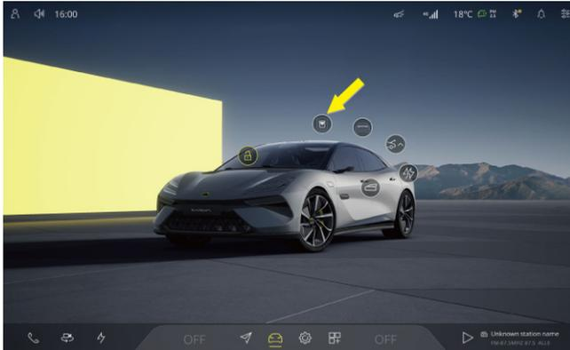
Vous pouvez appuyer sur l'icône dans l'Affichage de la Pile Centrale, puis sélectionnez l'icône **Toit ouvrant panoramique** pour passer à l'interface de réglage de la transparence.
