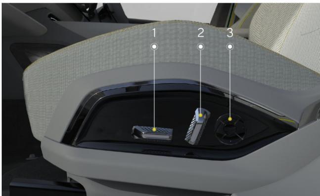
Interrupteur de réglage des sièges avant
