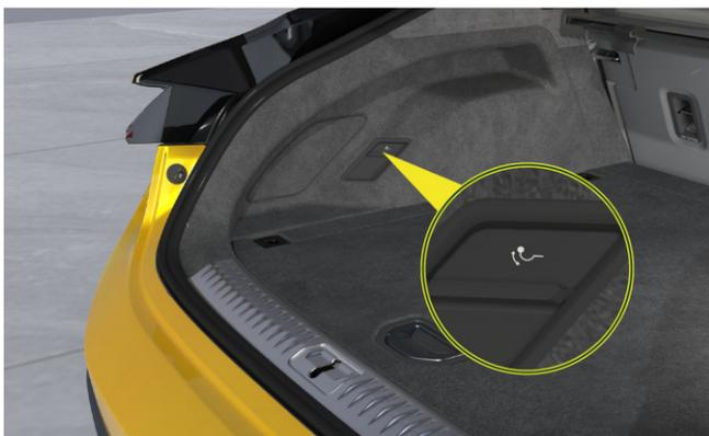
Interrupteur du crochet de remorquage électrique
