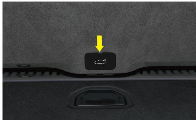
Déverrouillage d'urgence du couvercle de protection du hayon
