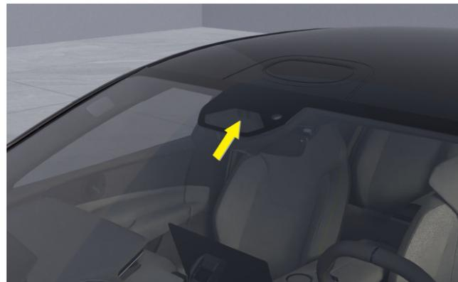
La fenêtre hyperfréquence est fixée horizontalement au centre, en position verticale vers le haut du pare-brise avant. Les informations sur le véhicule sont stockées dans la fenêtre hyperfréquence. Garder le pare-brise avant propre et empêcher les objets étrangers de bloquer la fenêtre hyperfréquence.
