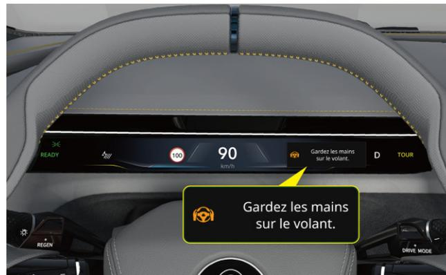
Lorsque LKA fonctionne, vous devez tenir le volant des deux mains à tout moment. Lorsque la LKA est activée pour la première fois et que le système détecte que vous ne tenez pas le volant, aucun message n'apparaît sur le combiné d'instrument. Si la LKA est à
