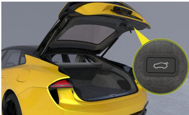
Interrupteur de fermeture du hayon
