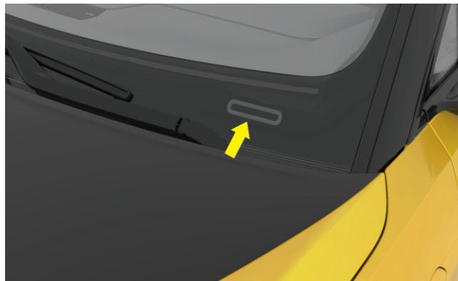
VIN dans le coin inférieur gauche du pare-brise
