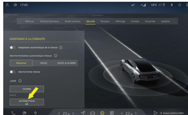
Lorsque le véhicule est sous tension et que le levier de vitesse est en position P, tous les lidars peuvent être nettoyés manuellement en un clic, selon les besoins. Le lidar ne peut pas être nettoyé manuellement dans l'une des conditions suivantes :
