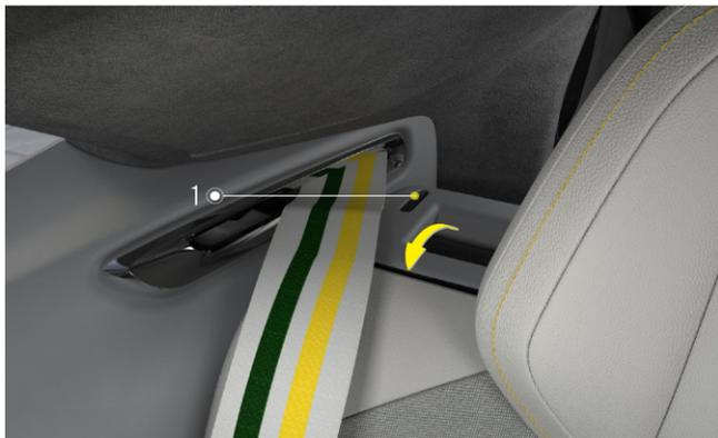
Dispositif de verrouillage situé à l'extérieur de l'appui-tête
