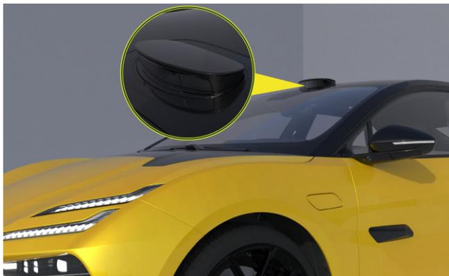
Ouvrez la **Fonction de bienvenue** ( p.119 )et lorsque le véhicule est déverrouillé, le LiDAR se déploiera et se repliera automatiquement.
