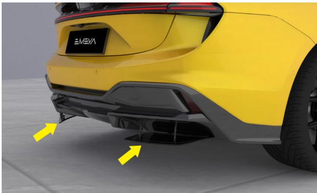
Le diffuseur arrière actif se trouve sous le pare-chocs arrière. Lorsque la vitesse du véhicule est supérieure à 90 km/h, le diffuseur arrière actif sera automatiquement activé. Lorsque la vitesse du véhicule est inférieure à 30 km/h, le diffuseur arrière actif, s'il est activé, sera automatiquement désactivé.
