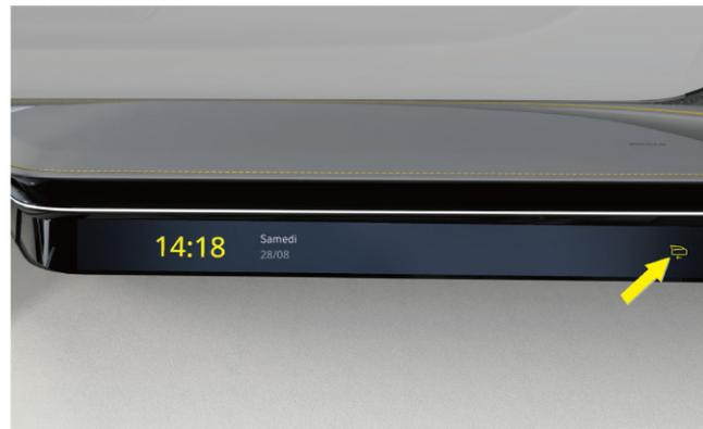
Interrupteur de fermeture de la porte du passager de l'écran du passager
