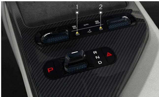
Verrouillage central sur la console du tunnel
