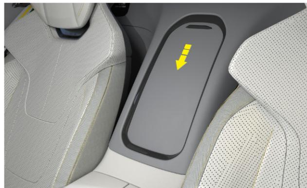
La poche du dossier du siège arrière est située au centre du dossier du siège arrière, elle peut être verrouillée si elle est poussée vers le bas jusqu'au fond et se refermera automatiquement si elle est pressée à nouveau.
