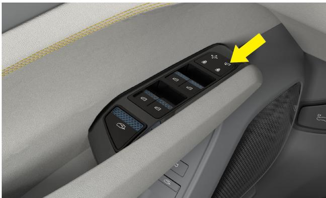
Commutateur de pliage des rétroviseurs extérieurs
