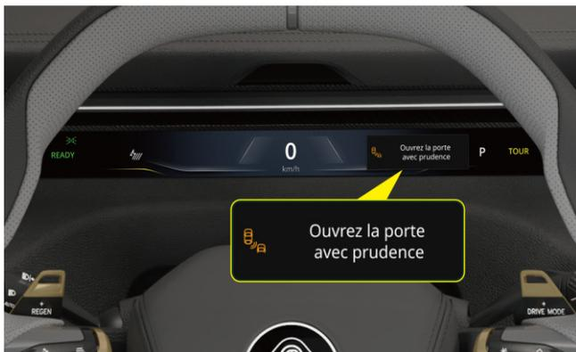
Si DOW détecte une cible et qu'il y a un risque de collision lors de l'ouverture de la porte, l'indicateur sur le rétroviseur extérieur s'allume ou clignote, accompagné d'une alarme sonore, et des images et des signaux d'alarme textuels s'affichent sur le groupe d'instruments.
