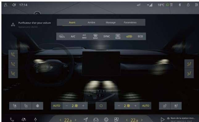
Sur l'interface de commande de la climatisation, double-cliquez pour activer le flux d'air correspondant, et double-cliquez à nouveau pour le désactiver. Appuyez sur le flux d'air et faites-le glisser pour régler la direction du flux d'air.
