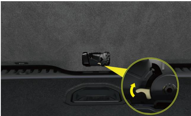
Déverrouillage d'urgence du levier de commande du hayon
