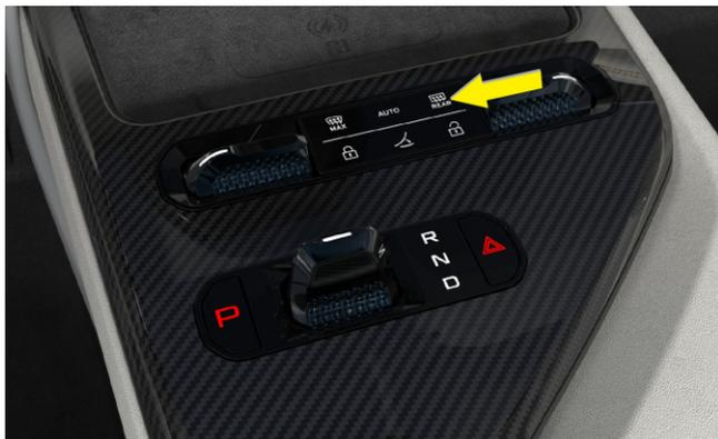
Chauffage des rétroviseurs extérieurs via la console du tunnel
