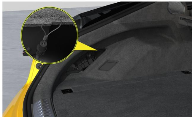
La corde de traction d'urgence pour serrure électronique est installée derrière le couvercle de réparation intérieure arrière gauche, dans le compartiment à bagages.
