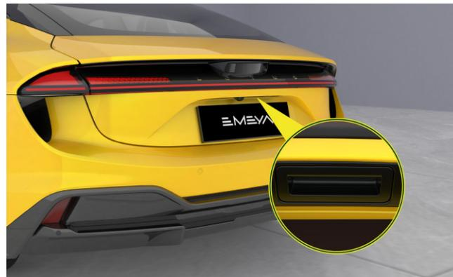
Interrupteur d'ouverture du hayon
