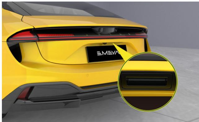
Déverrouillage d'urgence par l'interrupteur d'ouverture du hayon
