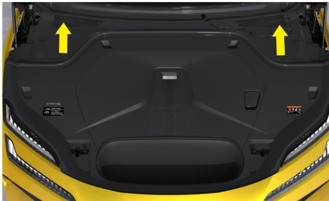
Des feuilles et des insectes peuvent s'accumuler au niveau des événements extérieurs de la climatisation, dans la grille sous l'arrière du capot, veuillez donc les nettoyer régulièrement pour éviter les blocages.
