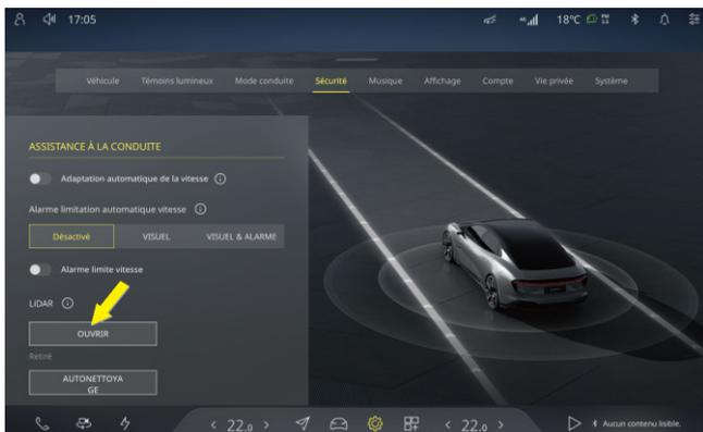
Lorsque le véhicule est sous tension et que le levier de vitesse est en position P, vous pouvez déplier manuellement tous les lidars en un clic, selon les besoins. Le lidar ne peut pas être déployé manuellement dans l'une des conditions suivantes :
