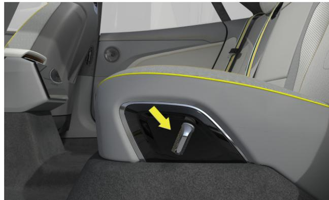
Réglage des sièges arrière pour le modèle à 5 places
