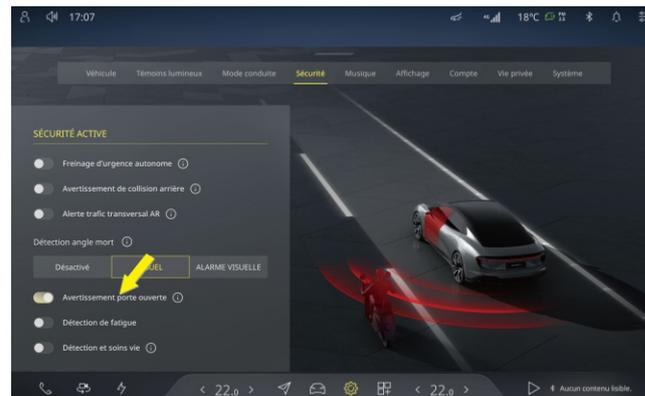
Vous pouvez cliquer sur l'icône dans le CSD, et sélectionnez **Sécurité** pour entrer dans l'interface de réglage de DOW, où la fonction DOW peut être activée ou désactivée.
