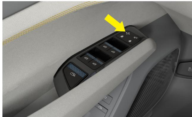
Commutateur de réglage des rétroviseurs extérieurs
