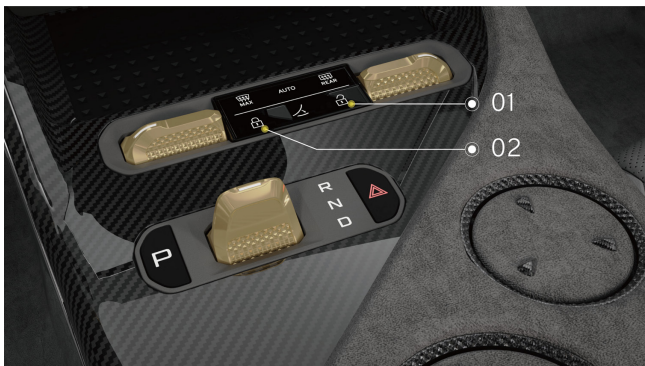
Centrale vergrendeling op de voorste tunnelconsole
