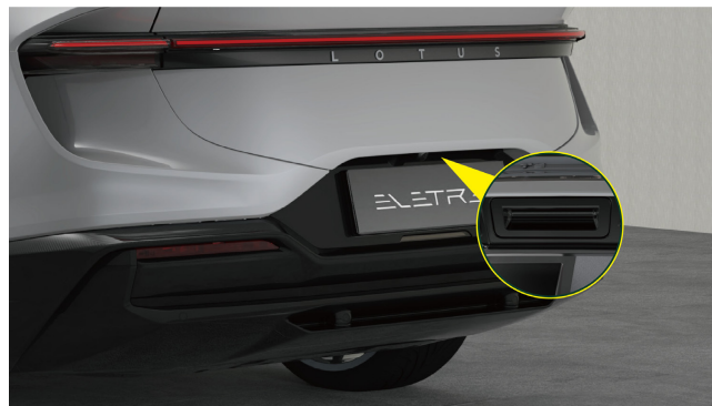
Noodontgrendeling via schakelaar voor openen achterklep
