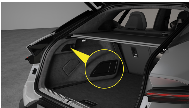
12 volt voeding in de bagageruimte
