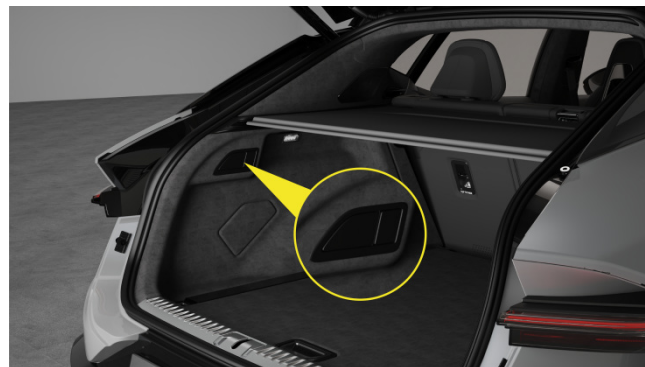
12V strømforsyning i bagagerummet
