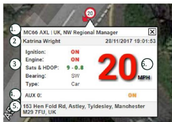
卫星数量和 HDOP（水平分量精度因子）。至少需要 3 颗卫星才能定位。HDOP 是衡量天空中卫星配置几何质量的指标。HDOP 是决定水平位置相对精度的一个因子。DOP 数值越小，几何精度越好。为了获得良好的 3D 定位，我们希望 HDOP 值始终小于 2.0。
