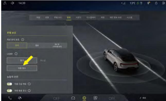
차량의 전원이 켜져 있고 기어 레버가 P 위치에 있을 때, 필요에 따라 한 번의 터치로 전면 LiDAR를 수동으로 청소할 수 있습니다. 다음과 같은 조건에서는 LiDAR를 수동으로 청소할 수 없습니다:
