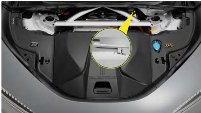
브레이크 오일 수위를 수시로 확인하여 수위가 최소와 최대 표시 사이에 있는지 확인하세요.
