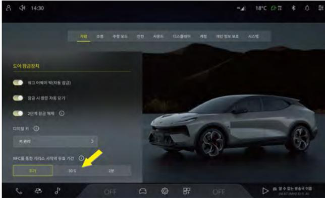
운전자는 리모트키/NFC 디지털 키로 차량의 잠금을 해제하고 차량에 탑승한 후 2분 이내에 브레이크 페달을 밟아 시동을 걸 수 있습니다. 차량이 2분 이내에 시동을 걸지 않으면 CSD가 그에 따른 안내 메시지를 표시합니다. 이때 리모트키/NFC 디지털 키를 무선 충전 유도 영역에 넣어야 합니다. 그런 다음 브레이크 페달을 밟아 시동을 걸 수 있습니다. 기어를 D 위치로 변속하면 차량을 주행할 수 있습니다.
