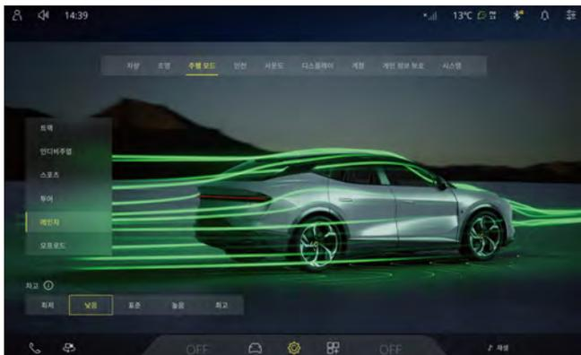
이 인터페이스에서는 주행 모드를 설정할 수 있으며, 일부 주행 모드에서는 차체 높이를 설정할 수 있습니다. 주행 모드에는 트랙 모드\*, 개인 모드, 스포츠 모드, 투어 모드, 범위 모드 및 오프로드 모드가 있습니다.
