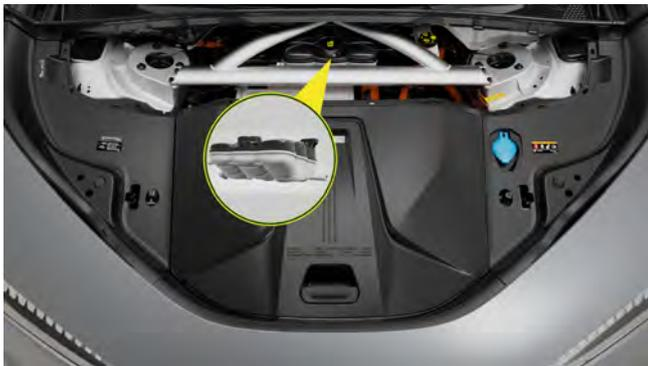
냉각수 수위를 수시로 확인하여 수위가 최소와 최대 표시 사이에 있는지 확인합니다.
