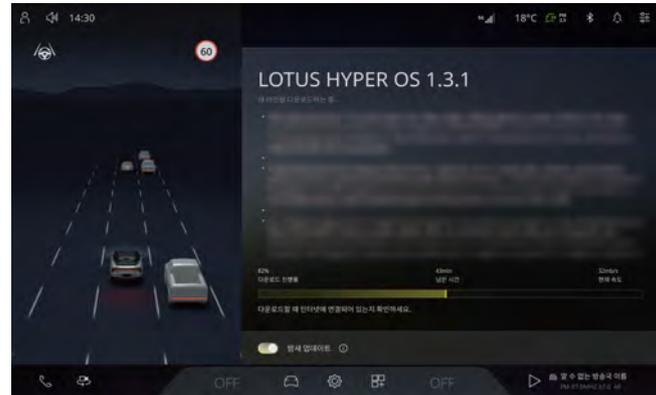
중앙 디스플레이 상단의 ↓ 아이콘을 클릭하거나 설정 🛠 인터페이스에서 **시스템 - 업데이트 확인**을 선택하여 OTA 시스템 업그레이드 인터페이스를 열 수 있습니다. 업데이트 정보 필드에는 업그레이드 목적, 항목, 업그레이드에 필요한 예상 시간, 업그레이드가 차량 기능에 미치는 영향 및 업그레이드와 관련된 참고 사항이 표시됩니다.
