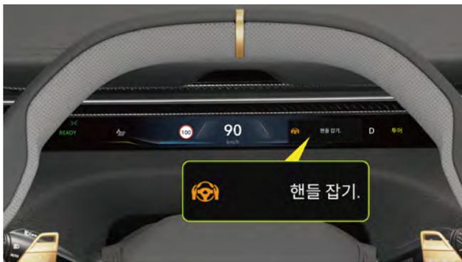
LKA가 작동하면 운전자는 항상 양손으로 스티어링 휠을 잡아야 합니다. LKA가 처음 활성화되고 시스템이 운전자가 스티어링 휠을 잡고 있지 않음을 감지하면 계기판에 안내 메시지가 표시되지 않습니다. 다음 시간 내에 LKA가 다시 활성화되고 시스템이 운전자가 여전히 스티어링 휠을 잡고 있지 않다고 감지하면 계기판에 "핸들을 잡고 계십시오"라는 메시지가 표시됩니다. 동시에 인수 인계 안내음이 발동됩니다.
