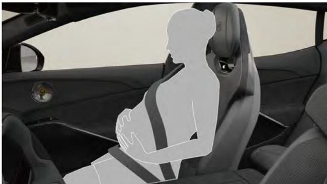
벨트의 대각선 부분은 어깨를 감싸고 가슴 사이와 복부 옆으로 이어져야 합니다. 벨트의 무릎 벨트 부분은 복부 아래에서 최대한 낮게 유지해야 하며 위로 올라가지 않도록 해야 합니다. 안전벨트가 느슨하지 않고 꼬이지 않았는지 확인하세요.
