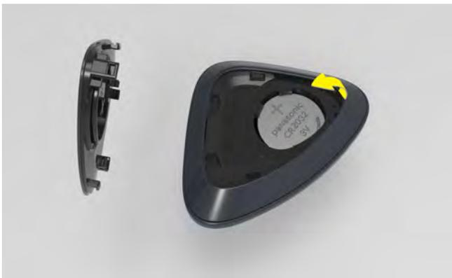
3. 골무 모양의 도구(차량에는 포함되지 않음)를 사용하여 틈을 끼우고 배터리를 들어 올립니다. 권장되는 새 배터리 유형은 다음과 같습니다: CR2032.
