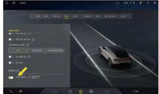
동승석 전면 에어백은 기본적으로 켜져 있으며, 동승석에 역방향으로 장착된 유아용 시트가 있는 경우 차량 충돌 시 에어백이 터지면 신체적 부상 및 불필요한 재정적 손실을 초래할 수 있습니다. 동승석에 어린이용 안전 시트를 설치할 때 반드시 아이코스를 클릭하고 **안전** 을 선택하여 조수석 에어백을 수동으로 끕니다.
