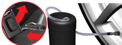
11. Placez le compresseur près du pneu, en veillant à ce que le flacon de produit d'étanchéité soit en position verticale.
