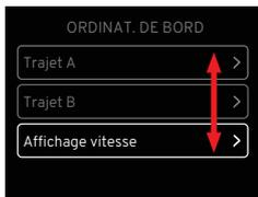
Dans le menu de l’ordinateur de bord, appuyez sur ou pour mettre en surbrillance l’affichage de la vitesse et appuyez sur pour le sélectionner.
