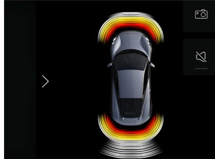
Lorsqu'il est actif, une image du véhicule s'affiche sur l'écran central, des champs de capteurs indiquent les objets détectés et leur proximité par rapport au véhicule.
