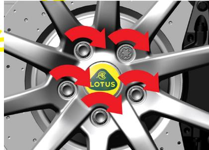
4. Serrez les 5 boulons de roue en croix à l'aide de l'extension standard et (et de l'adaptateur de boulon de roue codé si des boulons antivol sont montés).
