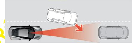
Le radar peut tarder à détecter les véhicules à faible distance, comme lorsqu'un véhicule s'interpose entre vous et celui qui vous précède.
