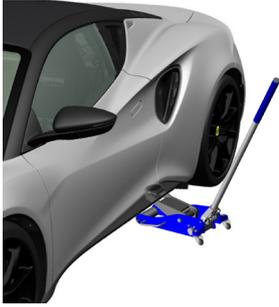
7. Placez un cric approprié au point de levage arrière identifié par un autocollant bleu, voir page 246, « Relevage du véhicule ». Cela vous permettra de relever les deux roues de ce côté du véhicule.
