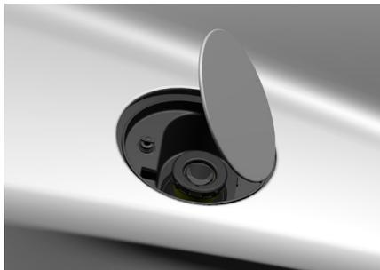
**Trappe de remplissage de carburant**
