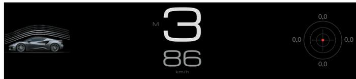
Lorsque l'écran du conducteur est en mode circuit, le widget Circuit sélectionné s'affiche à gauche de l'écran et l'autre option de menu sélectionnée s'affiche à droite.
