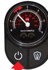
25. Libérez la pression excessive des pneus en appuyant sur le bouton
