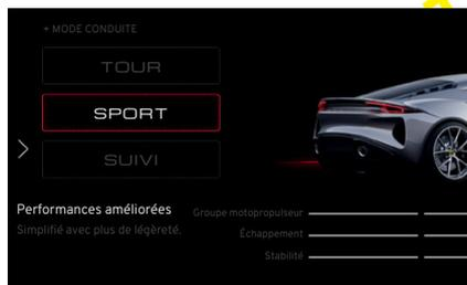
Une description des caractéristiques de conduite pour le mode sélectionné est affichée ainsi que le niveau d'intervention du groupe motopropulseur, du son d'échappement et du contrôle électronique de la stabilité disponibles, qui sont représentés par des barres lumineuses en bas de l'écran.
