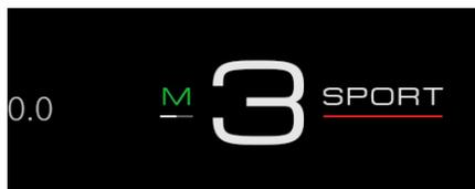
Si une palette n'est pas actionnée dans un intervalle de 20 secondes, la transmission revient en mode automatique en sélectionnant le rapport approprié, qui peut être différent du dernier rapport sélectionné manuellement.
