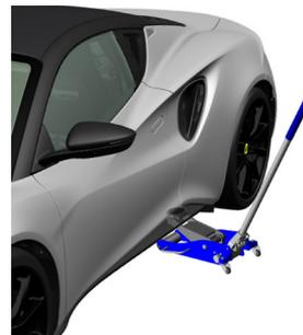
7. 青色のステッカーが貼られたリアリフティングポイントに、適切なジャッキをセットします。230ページの「車体のリフト」を参照してください。これでその側の両輪が上がります。
