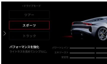
選択したモードの走行特性の説明に加え、パワートレイン、排気音、エレクトロニック・スタビリティ・コントロールの介入のレベルが、ディスプレイ下部に点灯するバーで表現されます。
