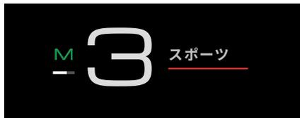
20秒以内にパドルを操作しないと、トランスミッションは自動モードに戻り、最後に手動で選択したギアとは異なる適切なギアが選択される場合があります。
