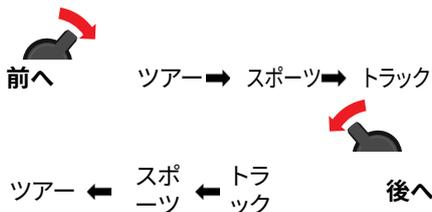
スイッチを1回動かすと、中央ディスプレイ内のポップアップ画面にアクティブドライブモードが表示されます。
