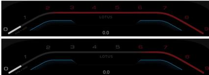
最大エンジン回転数は、エンジンのウォーミングアップ中、正常な運転温度に達するまで最大6,000 rpmまで徐々に上がり続け、エンジンウォームアップ中、赤線ゾーンに修正された最大回転数値が表示されます。
