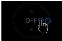
ディスプレイの内側を長押しして、速度を「7」または「OFF」に設定します。
