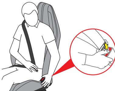
ベルトのバックルにある赤いボタンを押し、ベルトを巻き取らせます。
