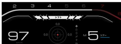
エンジン回転数の上昇に伴い、パフォーマンスシフトラインとシフトブロックがゆっくりと点滅し、**SHIFT** がドライバーに理想的なシフトポイントに到達したことを知らせます。
