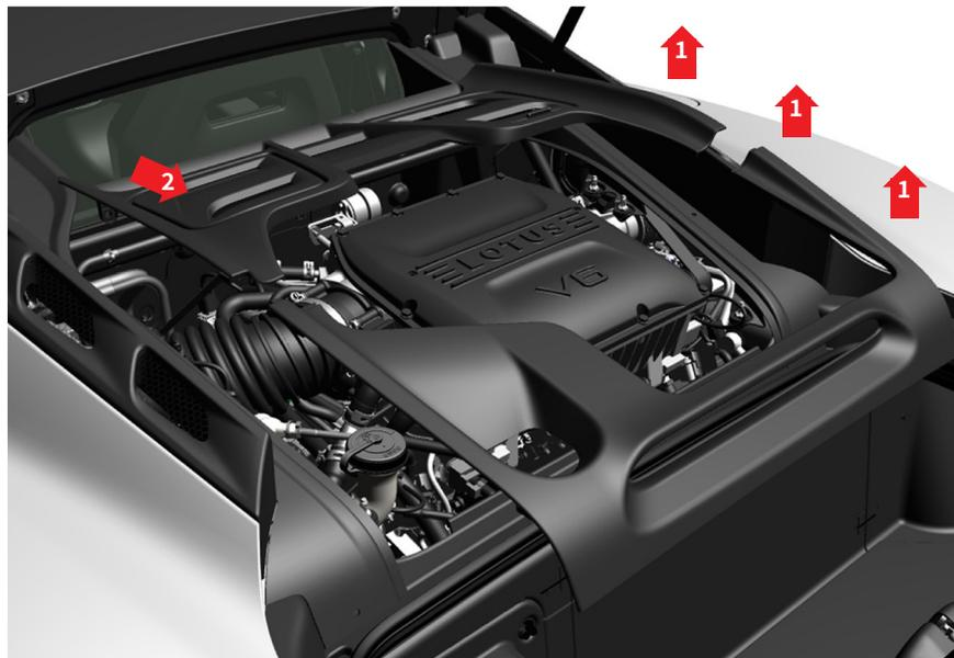
**📖 注記:** パネルが誤って破損するのを防ぐため、固定金具を下向きにして安全な場所に置いてください。
