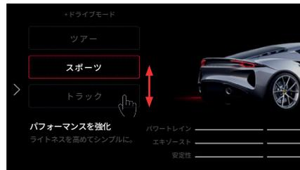
必要に応じて、ドライブモードスイッチを再び前または後に動かして新しいモード設定に切り替えるか、中央ディスプレイのモードボタンを押します。
