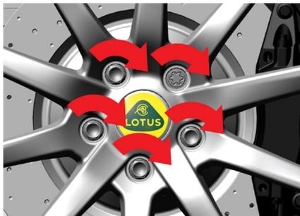
4. 標準のエクステンションとホイールボルトアダプター (ロック付ホイールボルトの場合はコード付ホイールボルトアダプター) を使って、5本すべてのホイールボルトを十字に締め付けます。
