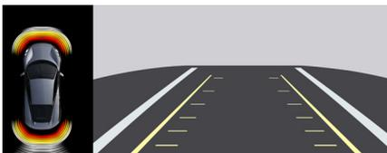
PACは、リバースギアを選択すると、いずれの速度でも自動的に起動します。また、中央ディスプレイの画面を使って手動で起動させることもできます。
