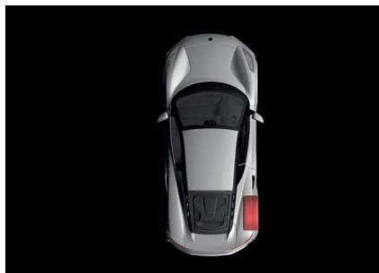
ⓘ タイヤ空気圧監視の警告マークは、1つまたは複数のタイヤの空気圧が著しく低下した場合に点灯し、ドライバーディスプレイの画面に警告メッセージが表示されます。79ページを参照してください。
