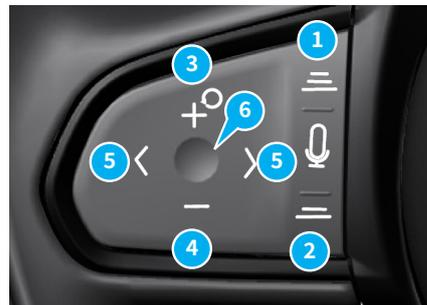
クルーズとアダプティブクルーズコントロールは、ステアリングホイール左側のキーパッドに設置のスイッチで操作します。
