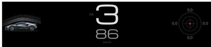
ドライバーディスプレイがトラックモードの場合、画面左側に選択中のトラック・ウィジェット、右側には選択中のその他のメニューが表示されます。
