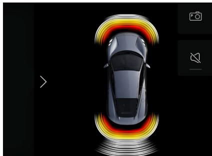
作動中は、中央ディスプレイに車両の画像が表示され、センサーエリアが、検出物体と車両との相対近接度を表示します。
