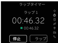
ラップボタンが強調表示されている状態で、もう一度○を押すと、タイマーが停止し、ラップタイムが記録されます。もしこれが最初のラップであれば、現在のベストラップタイムとして記録されます。
