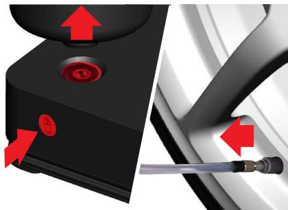
17. 12V補助電源ソケットからコンプレッサーのコネクターを外し、コンプレッサー側面のボタンを押してタイヤシーラントボトルを取り外し、タイヤのバルブキャップを装着します。
