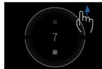
ディスプレイの外側を押してドラッグし、ファン速度を「7」に設定します。
