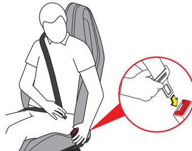
1. 背筋を伸ばし、シートに完全に腰掛けてください。シートベルトのタングプレートを持ち、リトラクターからベルトを引き出して身体を横切るようにします。
