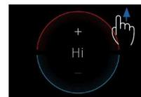
ディスプレイの外側を押しドラッグし、「Hi」温度を設定します。
