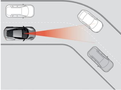
対向する強い光、車道の反射、路面の雪や氷、路面の汚れ、不明瞭な車線標識なども、道路標識情報のために道路を検視する際カメラの機能を著しく低下させることがあります。
