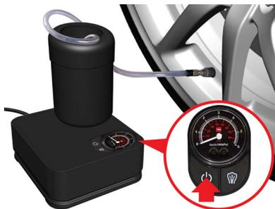
15. ON-OFFボタンを押して、コンプレッサーを起動します。
