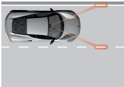
ウィンドシールド上部の後方に取り付けられたカメラが、道路方向とステアリングホイールの動きを比較しながら、利用できるいずれの車線表示をも監視します、
