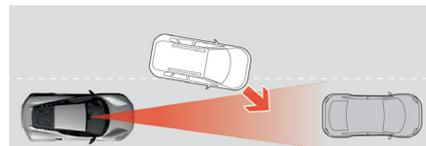
レーダーユニットは、自車と前方車両の間を走行する車両など、近距離の車両の検知が遅れることがあります。
