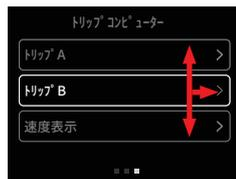
トリップコンピュータのメニューから、**◇**または **○** を押してトリップBを強調表示し、**○** を押して選択します。
