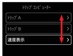
トリップコンピュータのメニューから、**◇**または **○** を押して「速度表示」を強調表示し、**○** を押して選択します。
