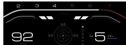
ギアシフトの指示を無視しエンジン回転数が最終シフトポイントを超えると、パフォーマンスシフトラインとブロックの点滅が速くなります。
