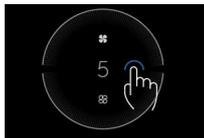
ディスプレイの内側をタップして、速度を1段階上げたり下げたりします。
