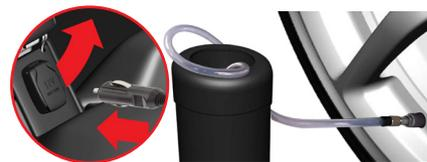
11. コンプレッサーをタイヤの近くに置き、シーラントボトルが直立していることを確認します。
