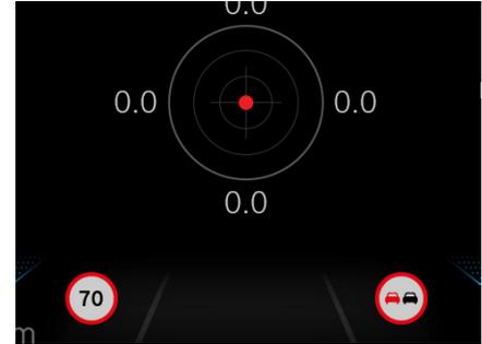
交通標識認識が有効の場合、車両が認識可能な道路標識を通過すると、ドライバーディスプレイの中央下部に記号で表示されます。
