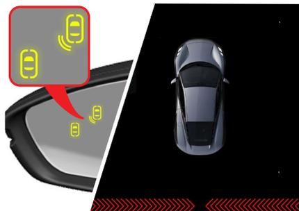
Lorsqu'un objet s'approchant de l'arrière du véhicule est détecté, les alertes suivantes sont activées :
