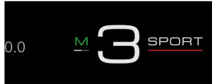
Si aucune palette n'est actionnée dans un intervalle de 20 secondes, la transmission revient en mode automatique en sélectionnant le rapport approprié, qui peut différer du dernier rapport sélectionné manuellement.
