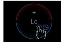
Une pression prolongée sur les touches « + » ou « - » permet de régler la température sur « Hi » (maximum) ou « Lo » (minimum).
