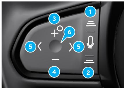
Le régulateur de vitesse et le régulateur de vitesse adaptatif sont actionnés à l'aide des interrupteurs situés sur le clavier de gauche du volant de direction.
