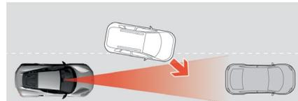
Le radar peut tarder à détecter les véhicules à faible distance, comme lorsqu'un véhicule s'interpose entre votre véhicule et celui qui vous précède.
