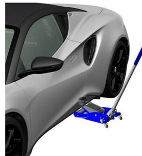
7. Placez un cric approprié au point de levage arrière identifié par un autocollant bleu, voir page 260, « Levage du véhicule ». Cela vous permettra de relever les deux roues de ce côté du véhicule.
