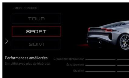
Une description des caractéristiques de conduite pour le mode sélectionné est affichée ainsi que le niveau d'intervention du groupe motopropulseur, du son d'échappement et du contrôle électronique de stabilité disponibles, qui sont représentés par des barres lumineuses en bas de l'écran.
