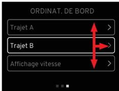
Dans le menu de l’ordinateur de bord, appuyez sur ou pour mettre en surbrillance Trajet B et appuyez sur pour sélectionner.
