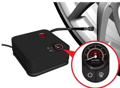
21. Sortez le kit et rebranchez le connecteur électrique du compresseur dans la prise d'alimentation 12 V du véhicule, en vous assurant que le bouton marche-arrêt est réglé sur arrêt.
