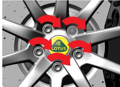
4. Serrez les 5 boulons de roue en croix à l'aide de l'extension standard et de l'adaptateur de boulon de roue codé (si des boulons antivol sont montés).
