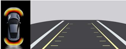
La caméra s'active automatiquement à n'importe quelle vitesse lorsque la marche arrière est sélectionnée, ou manuellement à l'aide de l'écran d'affichage central.
