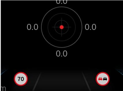
Si la reconnaissance des panneaux de signalisation est activée, dès que le véhicule passe devant un panneau de signalisation reconnaissable, celui-ci apparaît sous forme de symbole dans la partie inférieure centrale de l'affichage du conducteur.
