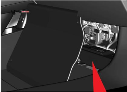
Le panneau de la plinthe est un élément de protection des occupants en cas de collision. Ne conduisez jamais le véhicule sans que le panneau de la plinthe soit installé et monté correctement.
