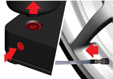
17. Débranchez le connecteur du compresseur de la prise de courant auxiliaire 12 V, appuyez sur le bouton situé sur le côté du compresseur pour détacher le flacon de produit anti-crevaison et remettez le bouchon de la valve du pneu en place.
