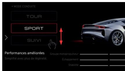
Déplacez à nouveau l'interrupteur du mode Drive vers l'avant ou vers l'arrière, selon les besoins, pour passer à un nouveau réglage de mode, ou appuyez sur le bouton de mode sur l'affichage central.
