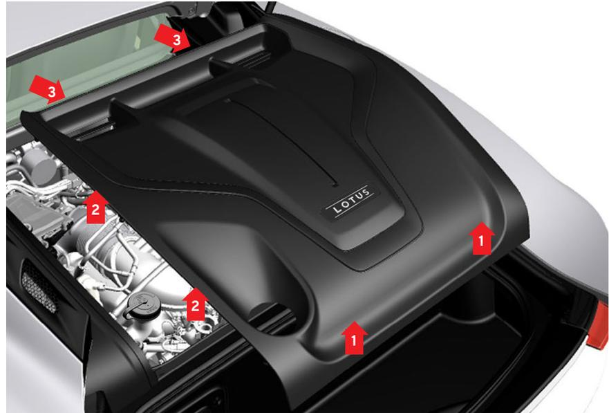
Avant de fermer le hayon, vérifiez que tous les panneaux du compartiment moteur ont été montés correctement et sont bien fixés.
