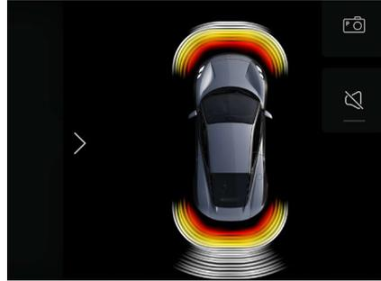
Lorsqu'il est activé, une image du véhicule apparaît sur l'affichage central, les champs des capteurs indiquent les objets détectés et leur proximité par rapport au véhicule.
