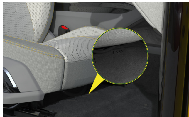
VIN-informasjon på tverrstangen på høyre forsete
