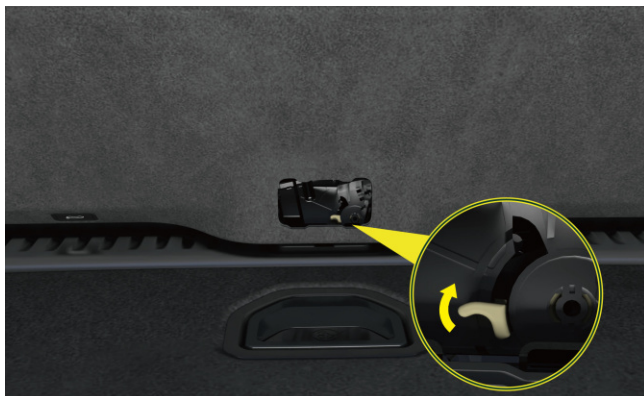
Nødopplåsing av kontrollspaken for bakluken
