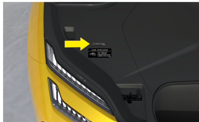
Posisjon på etikett for fremre drivmotor
