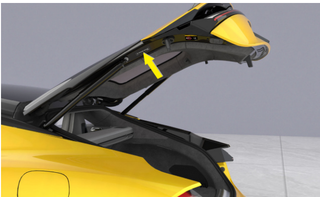
Posisjon på etikett for bakre drivmotor
