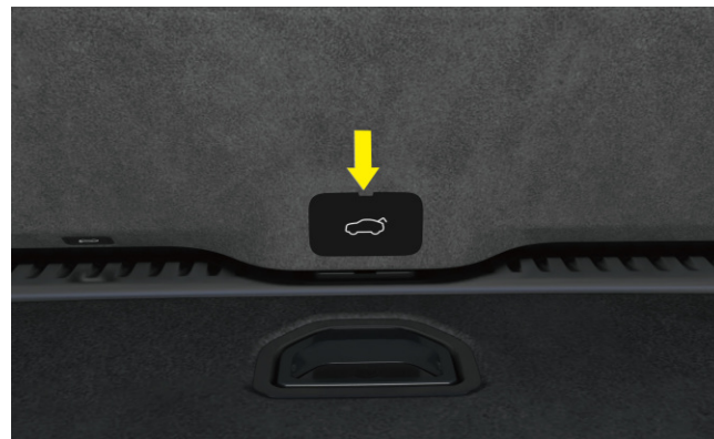
Nøddopplåsing av beskyttelsesdekselet til bakluken
