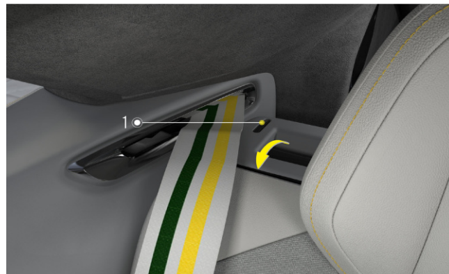
Låseanordning plassert på utsiden av nakkestøtten
