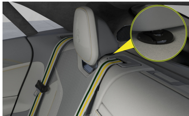
Knapp for justerbar nakkestøtte bak
