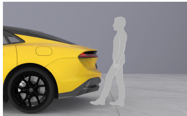
Induksjonssone for spark i bakluken
