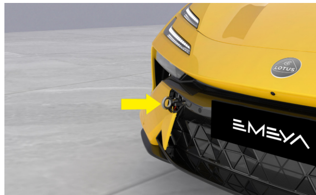
Monteringshull for tilhengerfeste i støtfanger foran
