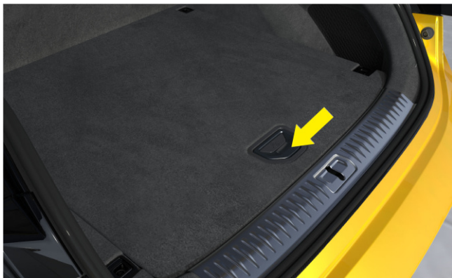
Lomme under bagasjeromsgulv
