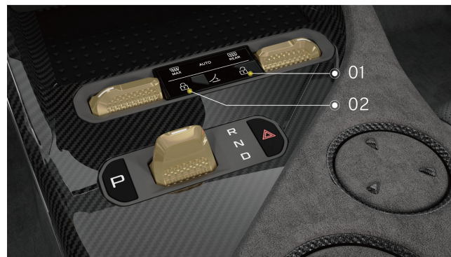
Sentrallås på den fremre tunnelkonsollen
