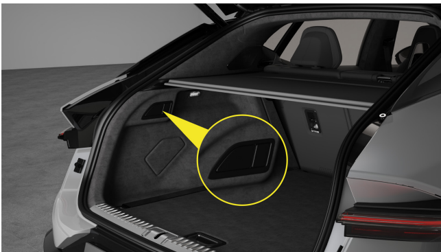
12-volts strømforsyning i bagasjerommet
